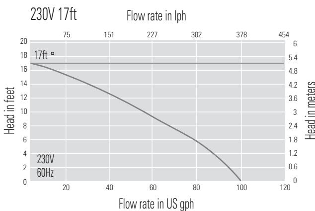
AC max unit sizing chart • Graphique des dimensions max de l'unité d'AC • Gráfica de potencias máximas de la unidad de aire acondicionado a las que puede funcionar la bomba
