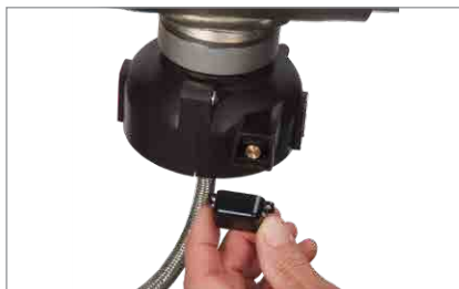
4. Retirez le couvercle antipoussière du capteur.
