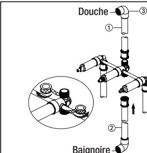
3. Enroulez le ruban d'étanchéité pour joints filetés autour du filetage du corps du robinet dans le sens des aiguilles d'une montre, comme illustré. Raccordez les tuyaux de sortie de la douche (1) et de la baignoire (2) au corps du robinet. Raccordez les coude de tuyaux (3) (non compris) aux extrémités des deux tuyaux et serrez à l'aide d'une clé.
