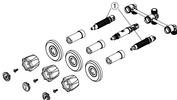
**Entretien:** Si le robinet fuit par la sortie du bec-coupez l'eau puis remplacez l'obturateur (1). Nota: Installer correctement les obturateurs (1) pour que les manettes tournent dans le bon sens.
