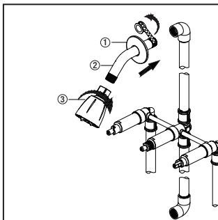
5. Insérez l'extrémité longue du bras de douche (2) à travers la collerette de douche (1), puis enroulez le ruban d'étanchéité pour joints filetés autour de l'extrémité longue du bras de douche (2) dans le sens des aiguilles d'une montre, comme illustré.
