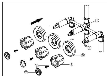
7. Placez les brides (5) sur les robinets (1). Fixez les poignées (4) aux tiges (6), puis fixez-les solidement avec les vis (3). Utilisez un tournevis cruciforme pour serrer les vis (3). Fixez les repères de température (2).
