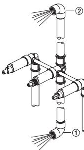
4. Pour les combinaisons baignoire et douche, ouvrez les conduites d'alimentation en eau chaude et froide pour permettre à l'eau de s'écouler de la sortie du bec de baignoire (1) jusqu'à ce que tous les débris soient éliminés de la conduite. Vérifiez tous les raccords à la recherche de fuites.
