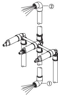
4. Para combinaciones de bañera y ducha, abre las líneas de suministro de agua fría y caliente, y deja que el agua salga por la tubería de salida del caño de la bañera (1) hasta que toda la suciedad sea expulsada de la línea. Revisa todas las conexiones para descartar filtraciones.
