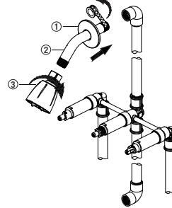
5. Inserta el extremo largo del brazo de la ducha (2) a través de la brida de esta (1) y coloca enseguida cinta selladora para rosca alrededor de aquel (2), en el sentido de las manecillas del reloj, tal como se muestra.
