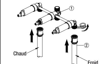
2. Enroulez le ruban d'étanchéité pour joints filetés autour des filetages du corps du robinet (1) dans le sens des aiguilles d'une montre, comme illustré. Vissez la conduite d'eau (2) sur le corps du robinet (1) et serrez à l'aide d'une clé.
