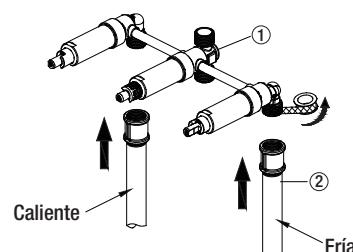
2. Coloca cinta selladora para roscas alrededor de las roscas del cuerpo de la válvula (1) en el sentido de las manecillas del reloj, como se muestra. Enrosca la línea de agua (2) en el cuerpo de la válvula (1) y apriétala con una llave.
