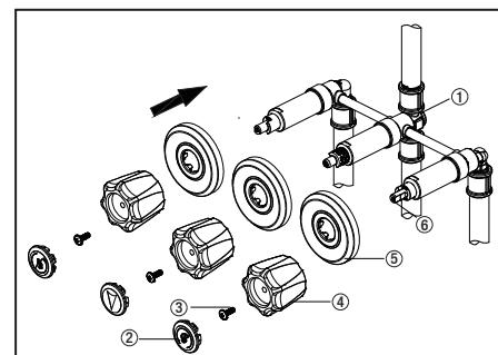
7. Coloca las bridas (5) en la válvula (1). Conecta las llaves (4) a los vástagos (6) y asegúralas con los tornillos (3). Usa un destornillador Phillips para apretar los tornillos (3). Fija los índices (2).
