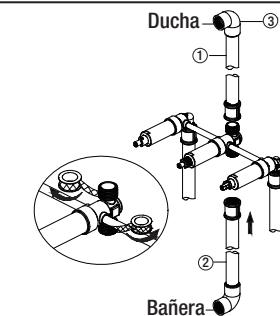
3. La cinta selladora que rodea la válvula se enrosca en el sentido de las manecillas del reloj, como se muestra. Conecta las tuberías de salida de la ducha (1) y la tubería de salida de la bañera (2) al cuerpo de la válvula. Conecta los codos de la tubería (no incluidos) a los extremos de ambos tubos y aprieta con una llave.
