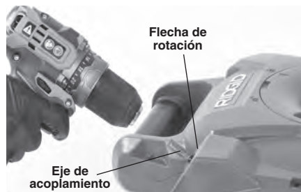
Figura 4 – Conexión del taladro al eje de acoplamiento
