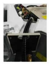
Fig. 16 —Install Conduit Assembly
