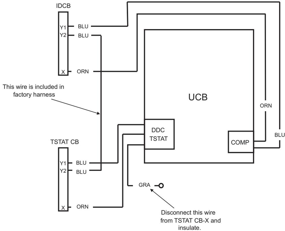
**Fig. 15 — 3-Stage Cooling Diagram**
