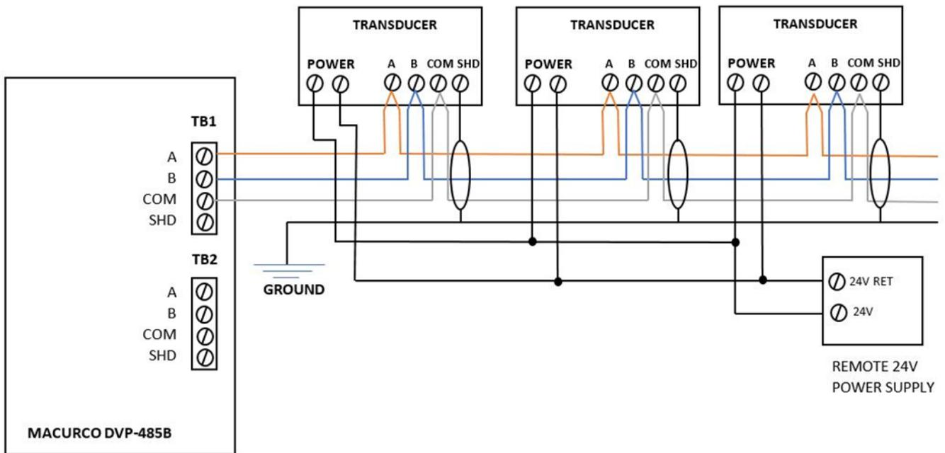
Figure 3-8 Modbus Wiring
