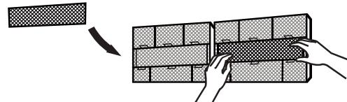
Retirez l'élément d'assainissement de l'air de l'arrière du filtre principal (certains appareils) et nettoyez avec un aspirateur portable.
