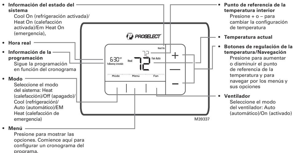
La pantalla se activará presionando cualquiera de los cinco botones. Si el suministro de energía se realiza desde el cable C, la pantalla permanecerá iluminada durante 45 segundos después de que efectúe los cambios. Si el suministro de energía se realiza desde las baterías únicamente, la pantalla permanecerá iluminada durante 8 segundos. Dependiendo de la forma como se instaló su termostato, la luz de la pantalla puede estar siempre encendida.
