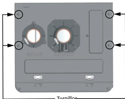
Figura 26 - Retire los tornillos de la placa superior.
