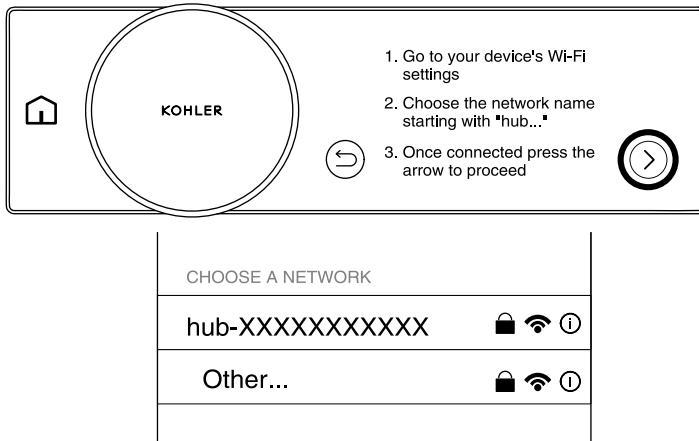
**REMARQUE :** Le module de commande du système est maintenant dans le mode de point d'accès et peut être découvert par les paramètres Wi-Fi de votre dispositif. Si aucune action n'est prise pendant 30 minutes, le module de commande du système ne sera plus en mode de point d'accès. Appuyer sur le bouton Précédent puis appuyer sur la flèche pour ramener le module de commande du système au mode de point d'accès.
