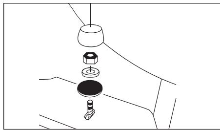
7. Posez les rondelles, les écrous et les capuchons sur les boulons à ergot de la bride. Évitez de trop serrer, car cela pourrait briser la porcelaine.
