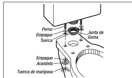
8. Installer le joint du réservoir à la cuvette ainsi que les boulons de réservoir avec les joints, rondelles et écrous fournis. Ensuite, fixer le réservoir à la cuvette en plaçant un joint, une rondelle et un écrou à oreilles sur chaque boulon saillant.
