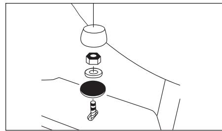
7. Instale las arandelas, tuercas y tapas en los pernos de la boca de desagüe. Tenga cuidado de no apretar demasiado, a fin de no dañar la superficie de porcelana.
