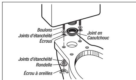
8. Instale el empaque entre el tanque y la taza y los pernos del tanque con los empaques, las arandelas y las tuercas suministrados. Después, fije el tanque a la taza colocando un empaque, una arandela y una tuerca de mariposa en cada perno sobresaliente.
