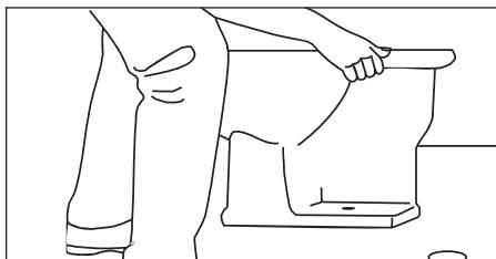
5. Posez délicatement la cuvette sur la bride, en vous assurant que les boulons de la bride traversent les orifices à boulon de la toilette.
