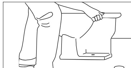
5. Coloque lentamente la taza en la boca de desagüe, asegurándose de que los pernos de la boca de desagüe sobresalgan a través de los agujeros correspondientes de la taza del inodoro.
