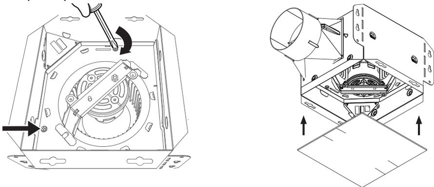
**8** Installer la bordure de la grille à l'aide des vis dans le sac de pièces.
