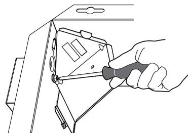
**7** Installer l'assemblage du ventilateur à l'aide des vis fournies. Brancher le ventilateur.
