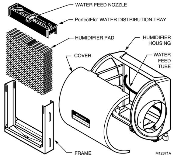
**Fig. 1. Humidifier components.**
