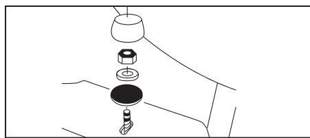
7. Posez les rondelles, les écrous et les capuchons sur les boulons à ergot de la bride. Évitez de trop serrer, car cela pourrait briser la porcelaine.
