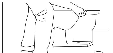
5. Coloque lentamente la taza en la boca de desagüe, asegurándose de que los pernos de la boca de desagüe sobresalgan a través de los agujeros correspondientes de la taza del inodoro.
