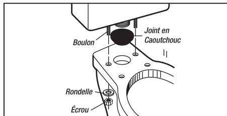
8. Faites le joint unissant le réservoir à la cuvette, posez les boulons et les rondelles du réservoir, si ce n'est pas déjà fait, et placez le réservoir sur la cuvette.
