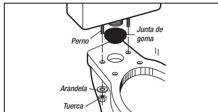
8. Instale la junta hermética (entre cisterna y taza), los pernos de la cisterna con arandelas (en caso de no estar ya instalados) y coloque la cisterna en la taza.
