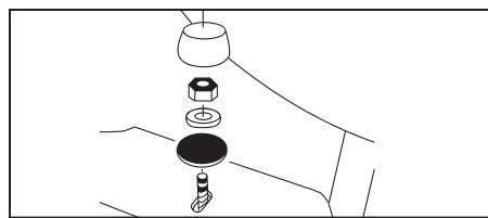
7. Instale las arandelas, tuercas y tapas en los pernos de la boca de desagüe. Tenga cuidado de no apretar demasiado, a fin de no dañar la superficie de porcelana.
