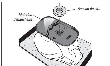
3. Placez la cuvette à l'envers et déposez-la sur la boîte de carton aplatie pour éviter de l'endommager.
