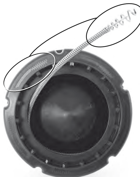
Obrázek 20 – Při navíjení kabelu do vnitřního bubnu kabel navíjejte VE SMĚRU HODINOVÝCH RUČÍČEK
