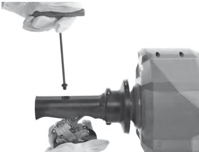
Figur 16A – Borttagning av AUTOFEED-mekanismen
