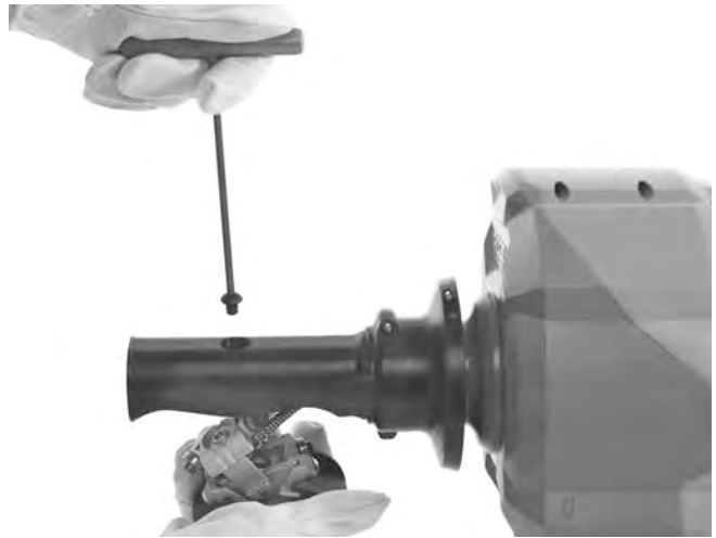
Figura 16A – Remoção do mecanismo AUTOFEED
