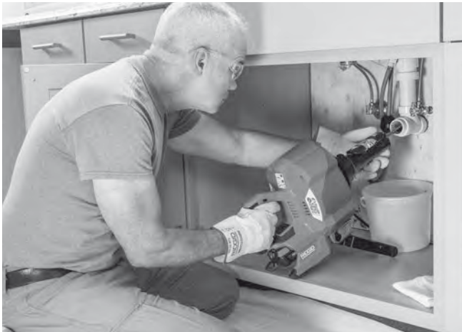
13-сурет – Кабельді AUTOFEED бөлігі арқылы өткізу
