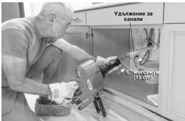
Фигура 6 – Пример за удължаване на дренажа до 6" (15 cm) от AUTOFEED блока
