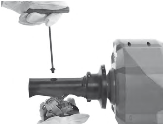
Figura 16A – Îndepărtarea mecanismului AUTOFEED
