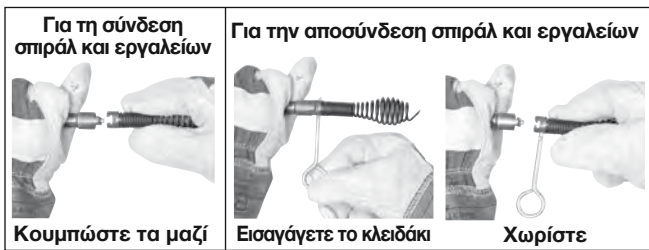
Εικόνα 7 – Σύνδεση και αποσύνδεση εργαλείων
