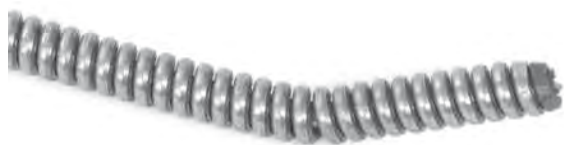
Figura 19 – Curbura de la capătul cablului
