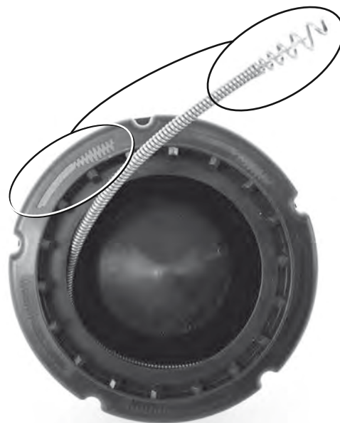
Figura 20 - Caricare il cavo in un tamburo interno avvolgendolo in senso ORARIO
