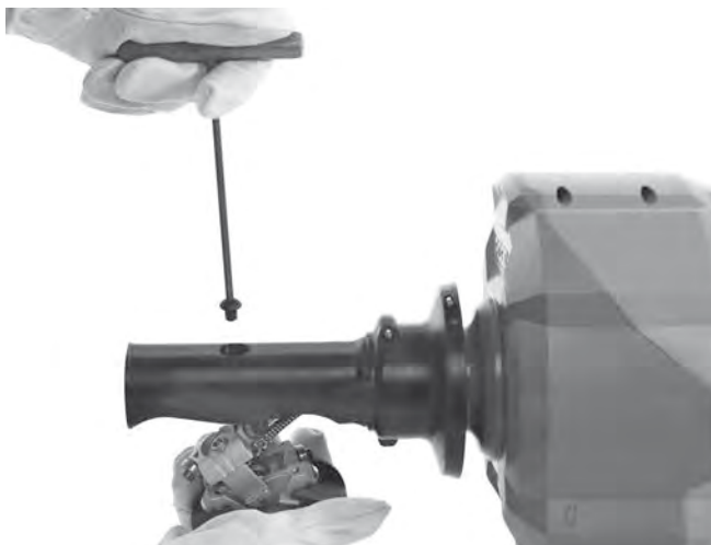
Фигура 16А – Демонтиране на механизма AUTOFEED
