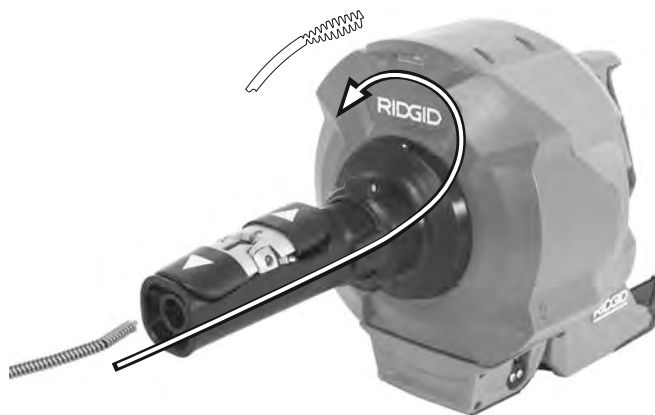
Rysunek 21 – Ładowanie sprężyny bez wymiany wewnętrznego bębna
