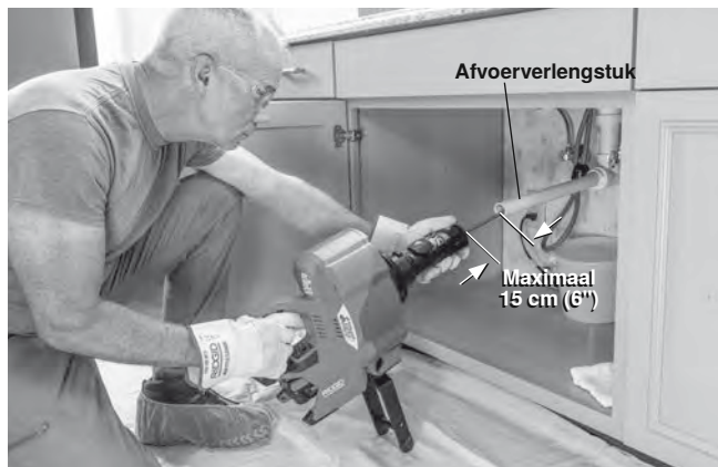
Afbeelding 6 – Voorbeeld van verlengen van de afvoerleiding tot binnen 15 cm (6") van de AUTOFEED-eenheid
