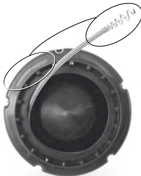
Εικόνα 20 – Κατά την τοποθέτηση του σπιράλ μέσα στο εσωτερικό τύμπανο, τυλίξτε το σπιράλ ΔΕΞΙΟΣΤΡΟΦΑ
