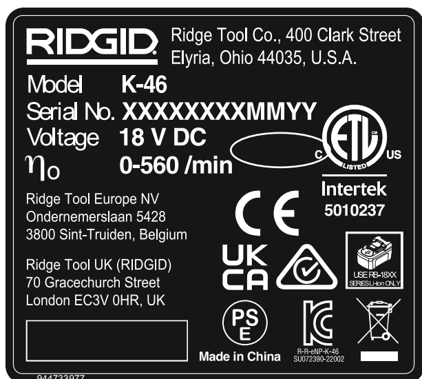
Slika 3 – Serijski broj stroja - Zadnje 4 znamenke serijskog broja označavaju mjesec i godinu proizvodnje (MMGG).
