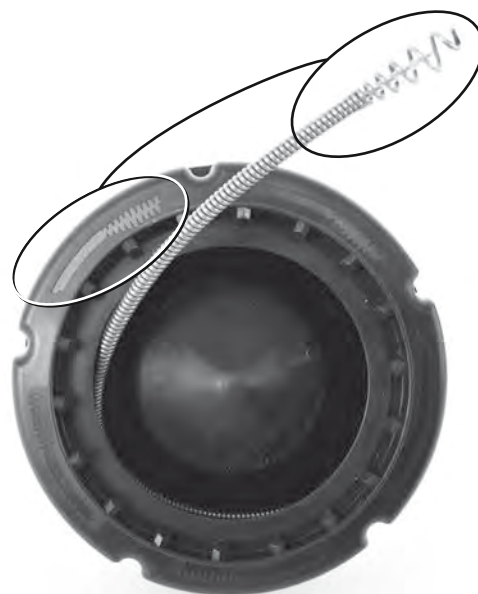
Figura 20 – Când încărcați cablul pe un tambur interior, înfășurați cablul ÎN SENS ORAR
