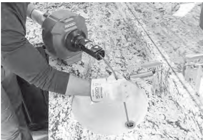
Figura 14 – Avançar o cabo manualmente
