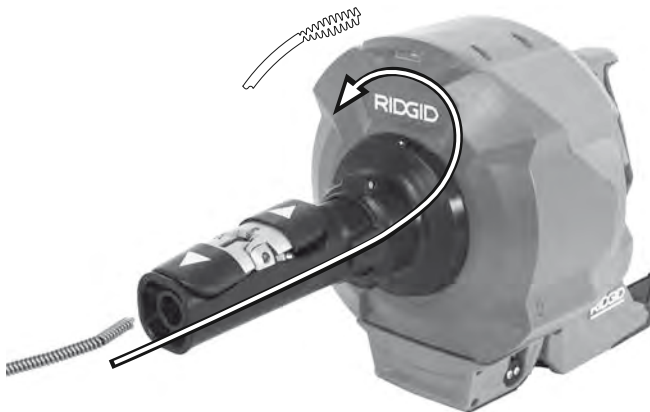
Figur 21 – Indføring af spiral uden skift af indertromlen
