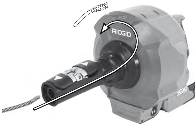
Figura 21 – Încărcarea cablului fără schimbarea tamburului interior
