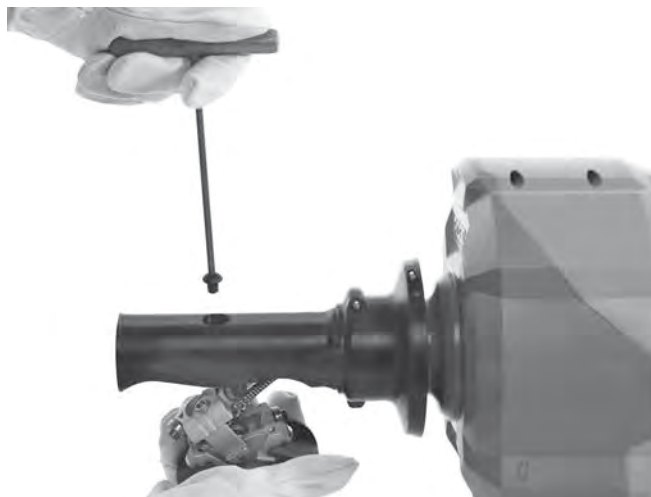
Slika 16A – Uklanjanje mehanizma AUTOFEED
