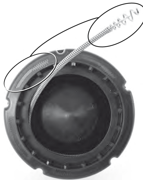
Slika 20 – Kada uvlačite sajlu u unutrašnji bubanj, namotavajte sajlu UDESNO
