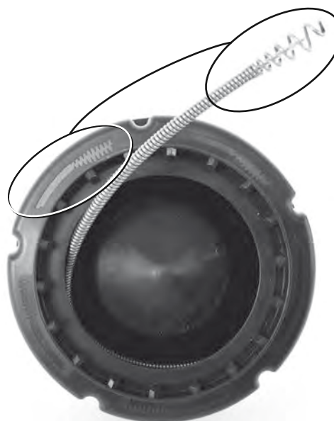
Rysunek 20 – Ładując wałek giętki do wewnętrznego bębna, zwinąć go W KIERUNKU ZGODNYM Z RUCHEM WSKAZÓWEK ZEGARA.
