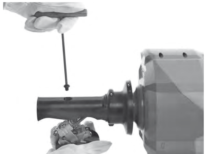
Afbelding 16A – AUTOFEED-mechanisme verwijderen
