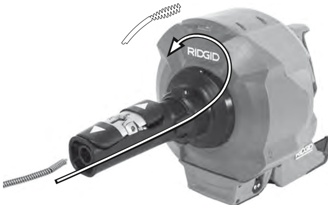
Figura 21 – Carregar o cabo sem substituir o tambor interno
