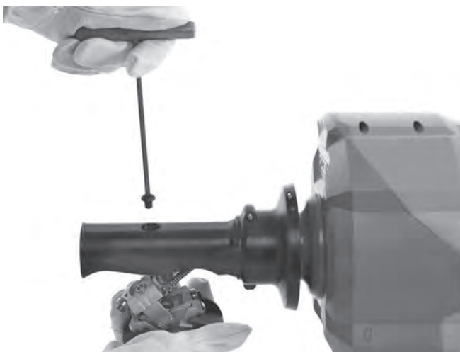
Figura 16 A – Extracción de la unidad AUTOFEED
