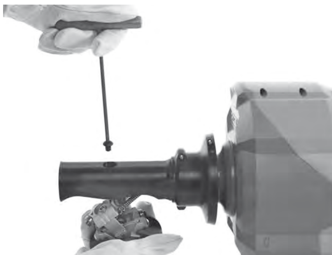
Figur 16A – Fjerne AUTOFEED-mekanismen
