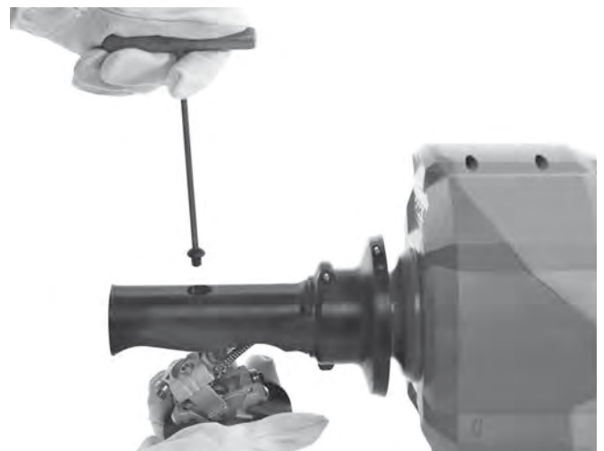
Σχήμα 16A – Αφαίρεση του μηχανισμού AUTOFEED
