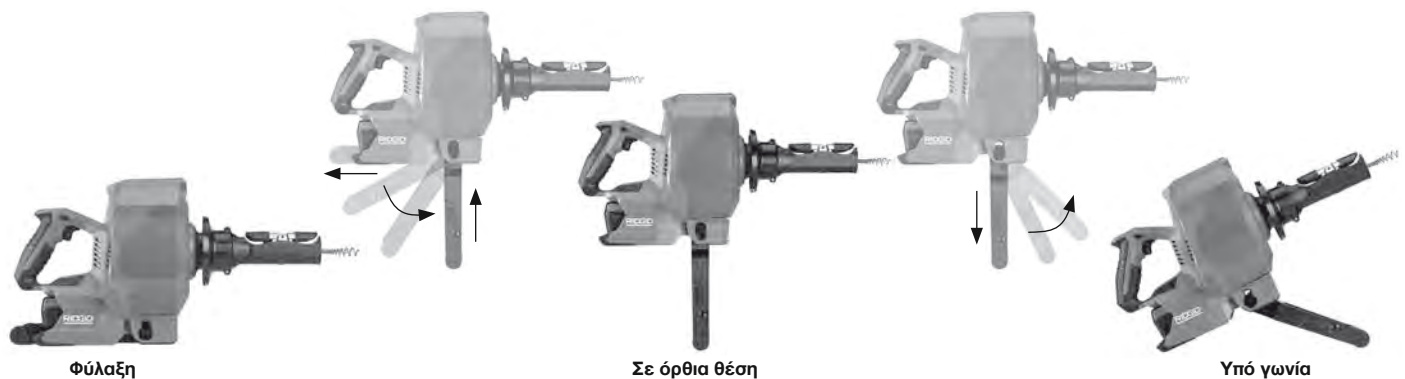
Εικόνα 8 – Ρύθμιση του εξαρτήματος ανάκλισης
