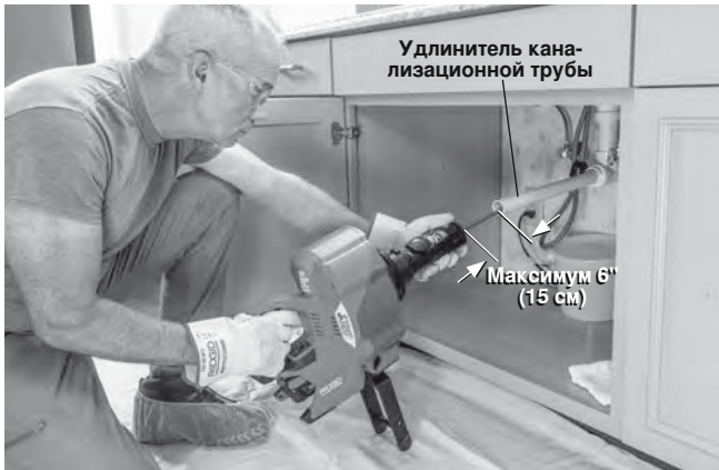
Рисунок 6 – Пример удлинения стока до расстояния 6" (15 см) от устройства автоподачи.
