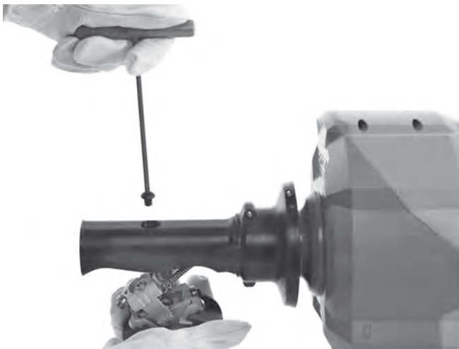
Obrázok 16A – Demontáž mechanizmu autoposuvu AUTOFEED
