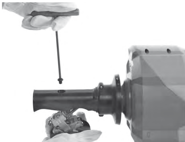
Obrázek 16A – Demontáž mechanismu AUTOPOSUVU
