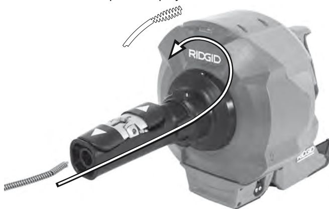
Slika 21 – Vstavljanje kabla brez menjave notranjega bobna
