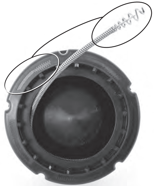
Figure 20 – Enroulez le câble en sens HORAIRE lors de son chargement dans un tambour interne
