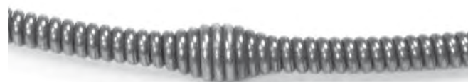
Slika 15 – C-13-IC SB kabel s pokazateljem konca kabla s "hitrostno oviro" je pribl. 5' (1,5 m) od zadnjega dela kabla
