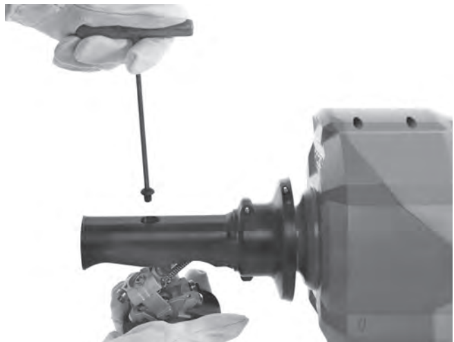
図 16A – AUTOFEED 機構を取り外す
