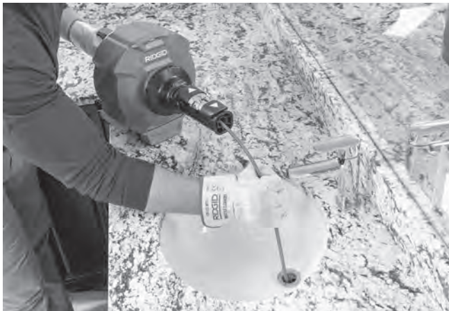
Figura 14 – Alimentación manual del cable
