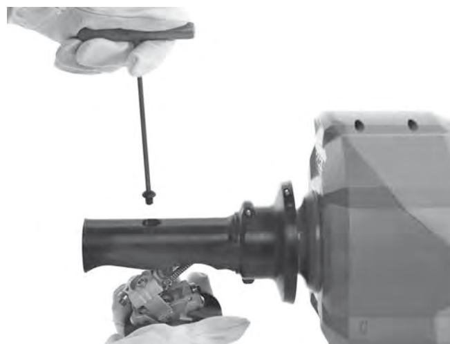
Figur 16A – Fjernelse af AUTOFEED-mekanismen
