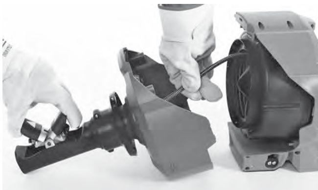
Slika 18 – Podajanje spirale v boben
