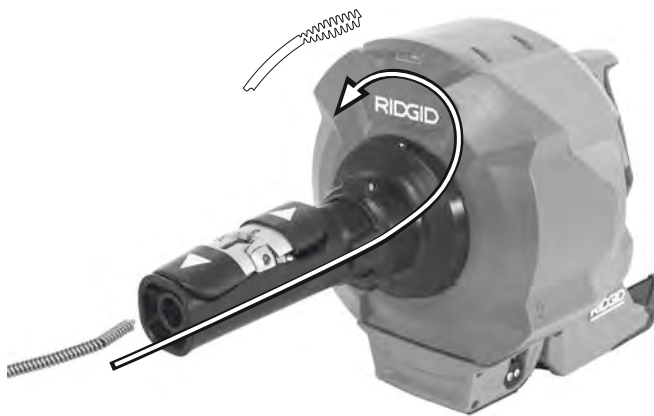
Рисунок 21 – Заправка троса без замены внутреннего барабана
