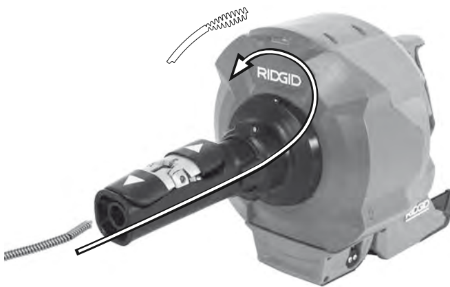
Figura 21 - Caricamento del cavo senza sostituire il tamburo interno
