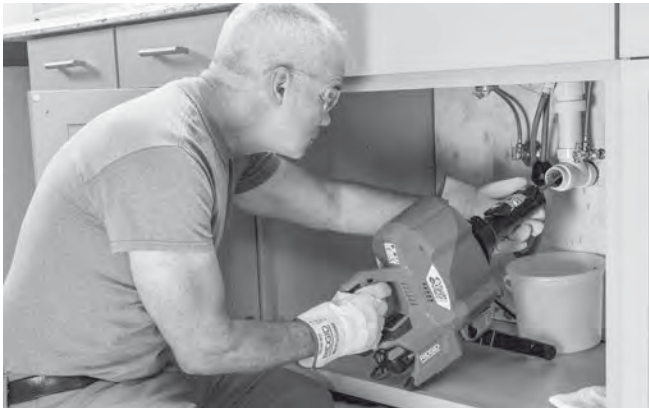
Rysunek 13 – wprowadzanie wałka giętkiego za pomocą jednostki AUTOFEED
