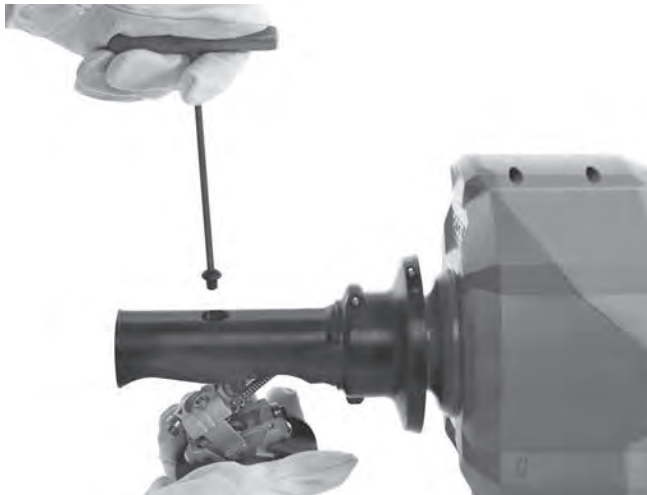
Abbildung 16A - Ausbau des AUTOFEED Mechanismus
