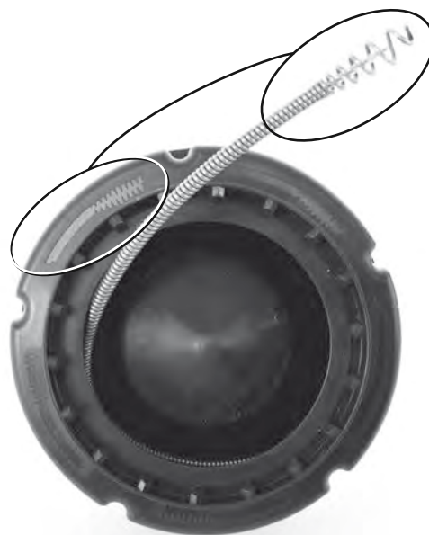
Рисунок 20 – При заправке спирали во внутренний барабан наматывайте спираль ПО ЧАСОВОЙ СТРЕЛКЕ
