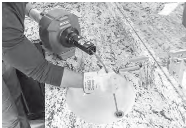
Obrázok 14 – Manuálny posuv špirálového kábla
