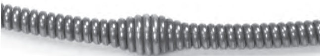
图 15 — 带钢索头指示器限位的 C-13-IC SB 钢索距钢索后端约 5' (1.5m)
