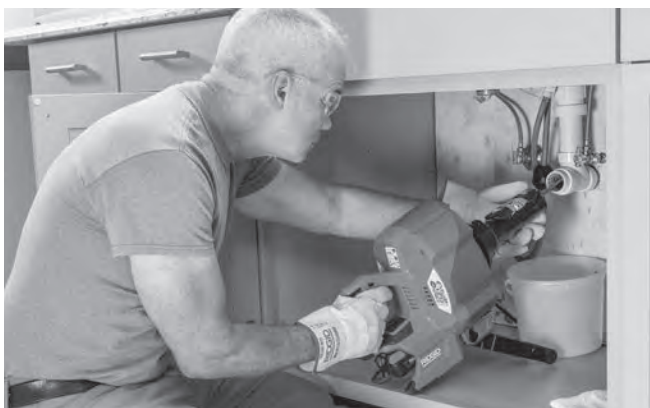
Figure 13 – Avancement du câble à l'aide du système AUTOFEED
