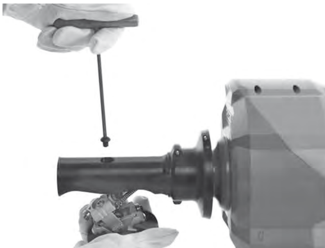
Slika 16A – Odstranjevanje mehanizma AUTOFEED
