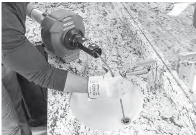
Rysunek 14 – Ręczne podawanie sprężyny
