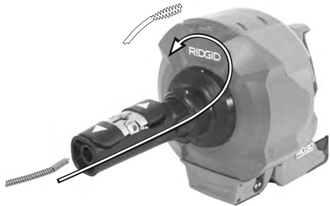
Afbeelding 21 – Veer laden zonder de binnentrommel te vervangen
