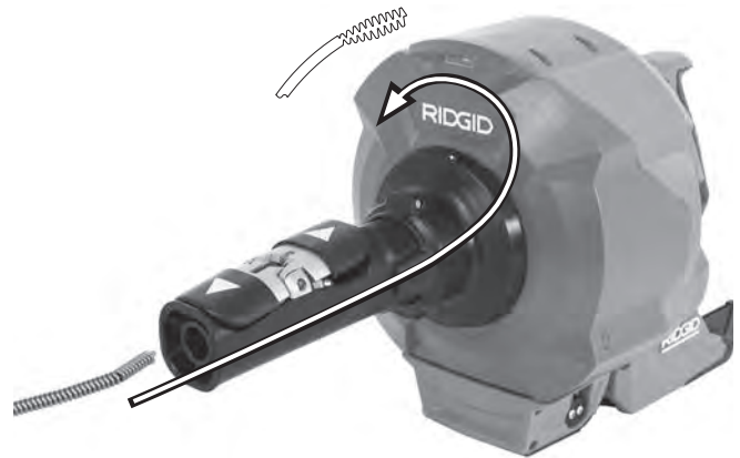
Abbildung 21 – Einlegen der Spirale ohne Wechsel der Innentrommel
