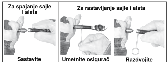
Slika 7 – Spajanje i odvajanje alata
