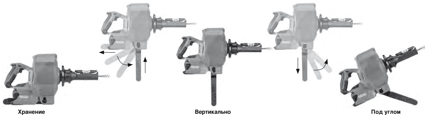
Рисунок 8 – Регулирование откидной ножки
