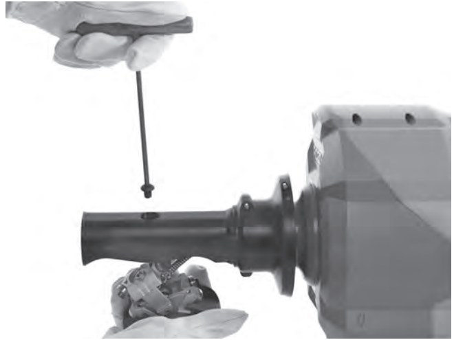
그림 16A - AUTOFEED 장치 제거
