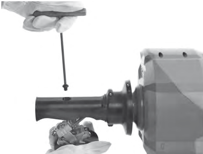
Figura 16A - Rimozione del meccanismo AUTOFEED
