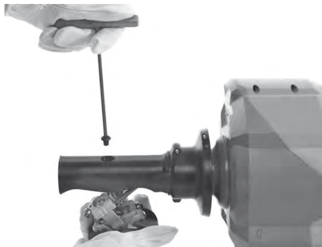
Рисунок 16А – Снятие механизма автоподдачи
