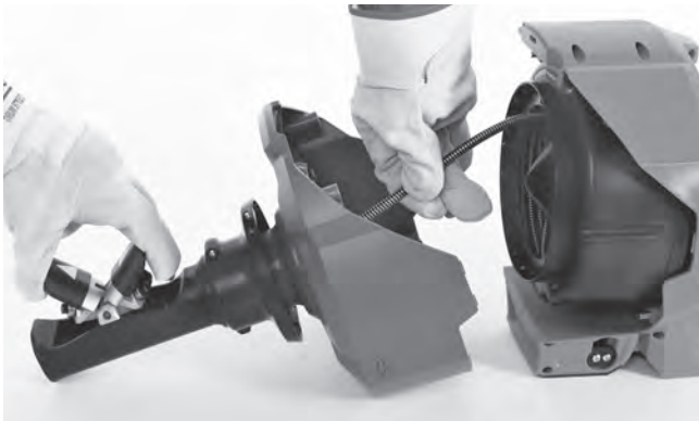
図 18 - ケーブルをドラムに送り込む
