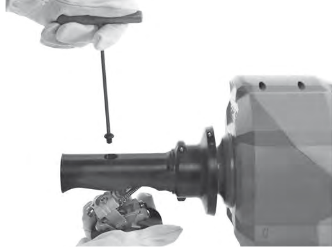
Şekil 16A – AUTOFEED Mekanizmasının Çıkarılması
