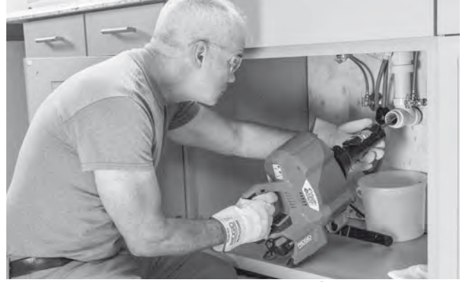
Şekil 13 – Kablonun AUTOFEED Ünitesi İle Beslenmesi
