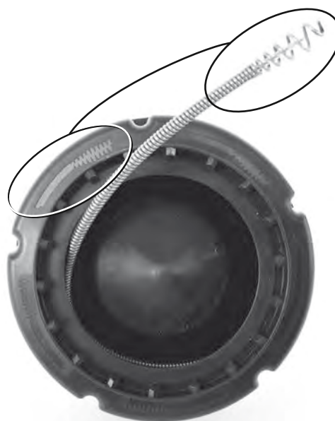
Figur 20 – Ved ilægning af spiralen i indertromlen vikles den I URETS RETNING
