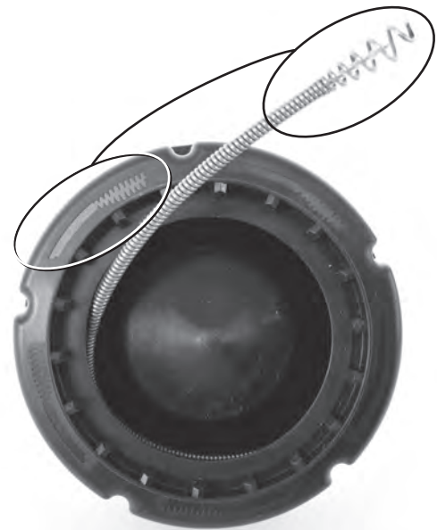
図 20 - ケーブルを内部ドラムに収納する際は、ケーブルを時計回りに巻き入れる
