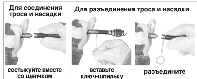
Рисунок 7 – Подсоединение и отсоединение насадок
