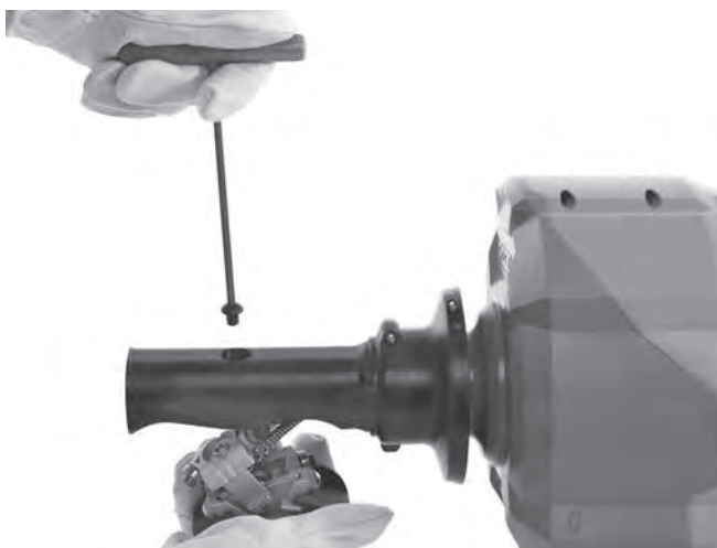
Figure 16A – Retrait du mécanisme de l'AUTOFEED
