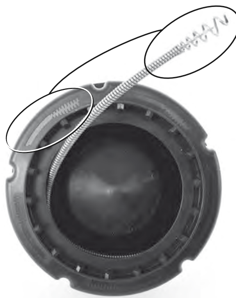
Slika 20 – Ko vstavljate spiralo v notranji boben, navijte spiralo V SMERI URNEGA KAZALCA.
