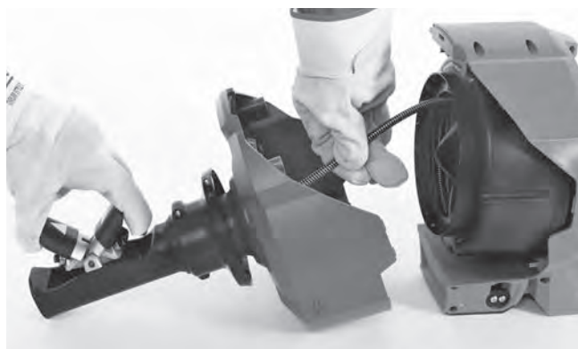
Figure 18 – Enroulage du câble dans le tambour
