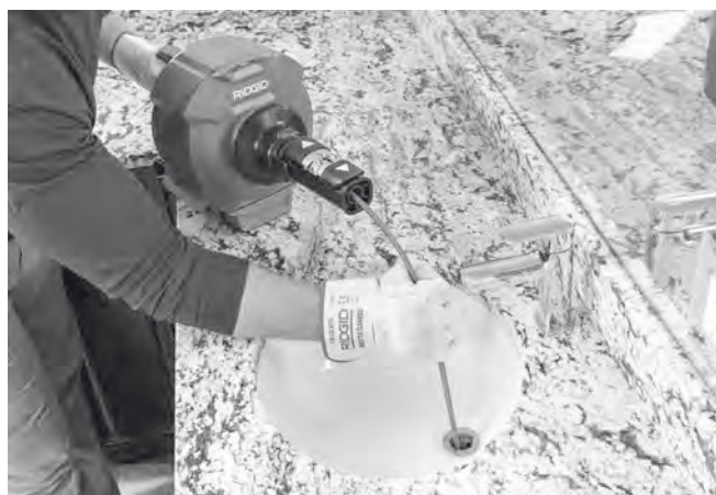
Figur 14 – Manuell frammatning av spiralen
