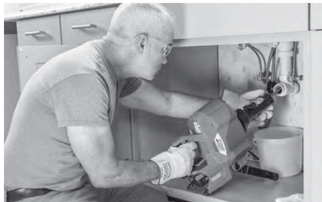
Obrázok 13 – Zavádzanie kábla pomocou jednotky autoposuvu AUTOFEED
