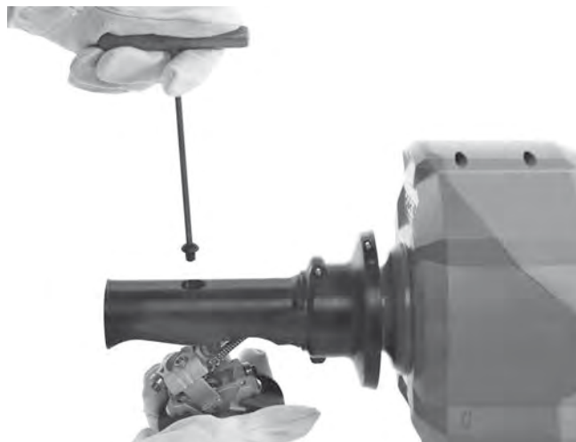
Rysunek 16A – wymontowanie mechanizmu AUTOFEED
