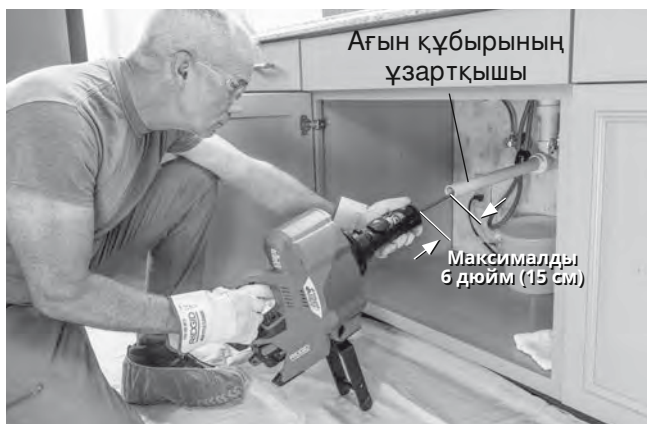
6-сурет – Ағын құбырын AUTOFEED бөлігінен 6 дюйм (15 см) шегінде созу үлгісі.
