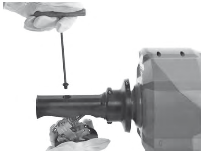
Slika 16A – Uklanjanje mehanizma AUTOFEED
