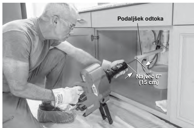
Slika 6 – Primer podaljšanja odtoka do 6" (15 cm) enote AUTOFEED
