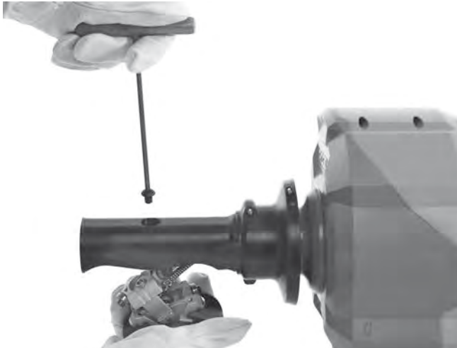
Kuva 16A - AUTOFEED-mekanismin irrottaminen
