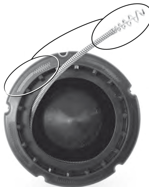
Figur 20 – Når du laster kabelen inn i en innertrommel, dreier du kabelen med urviseren
