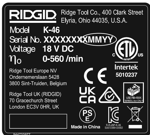
Figura 3 - Numero di serie della macchina - Le ultime 4 cifre indicano il mese e l'anno di produzione (MMAA).
