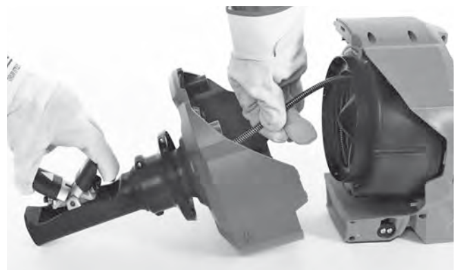
Figura 18 – Introducerea cablului în tambur
