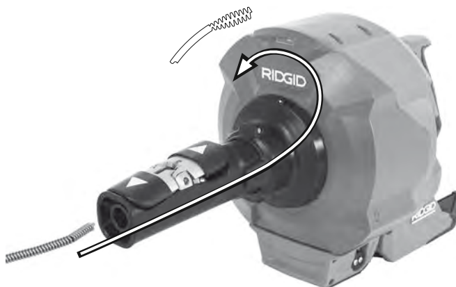
Figur 21 – Lasting av kabel uten å skifte innertrommel
