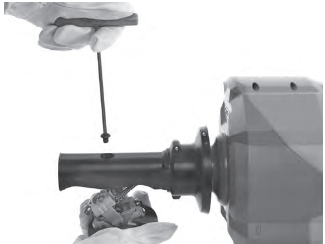
图 16A – 移除 AUTOFEED 自动进给机构
