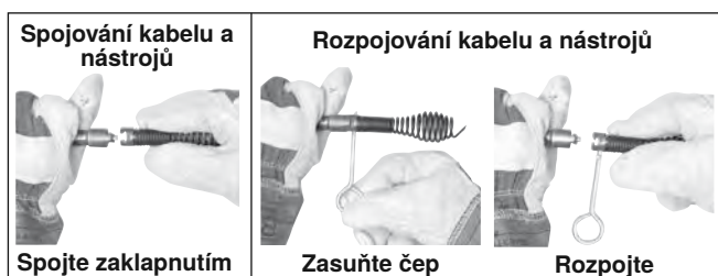
Obrázek 7 – Připojení a odpojení nástrojů
