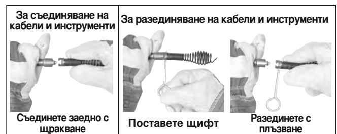
Фигура 7 – Съединяване и разединяване на инструменти
