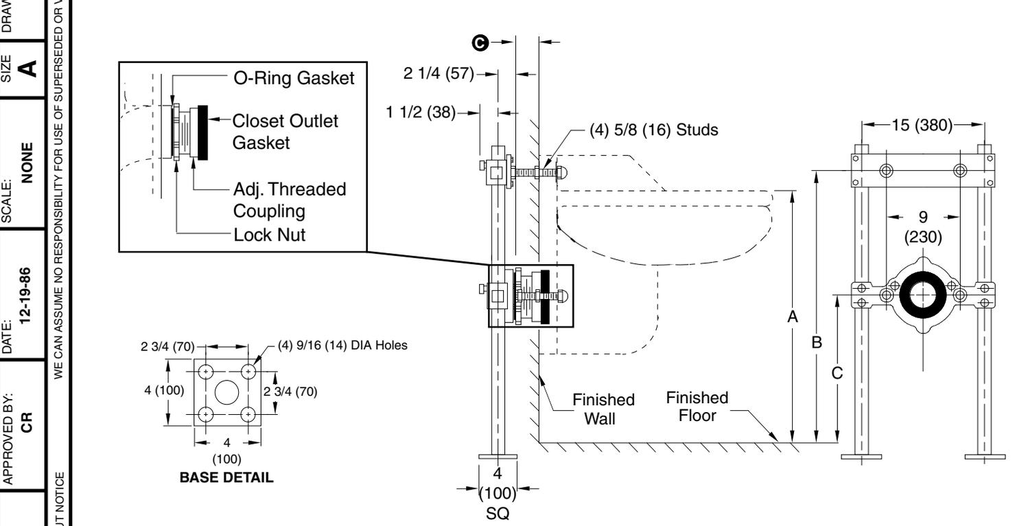
**Fig. 0913. .... 3" (80) OUTLET CONNECTION**
