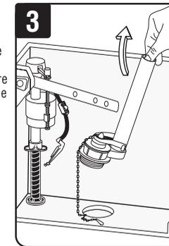
Retire la empaquetadura que une el tanque con la taza y la tuerca grande de la válvula para descarga de inodoro antigua. Luego retire la válvula para descarga de inodoro del tanque.
