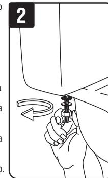
Destornille el tanque de la taza, luego levante el tanque y póngalo sobre una superficie estable y suave. Retire cualquier arandela de goma restante, la tuerca hexagonal y los pernos.
