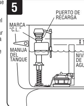
Quando instale el tubo de desborde de la válvula para descarga de inodoro, la parte superior de éste debe estar al menos 7,62 cm por debajo de la parte superior de la válvula de llenado.
