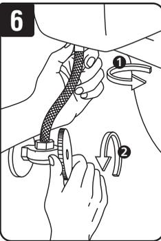
Vuelva a conectar la tubería de descarga en el tanque en la parte inferior de la válvula de llenado (1). Abra el suministro de agua y revise si hay fugas. Si hay fugas, gire la tuerca sólo lo suficiente para evitar fugas. Luego, descargue el inodoro para verificar.
