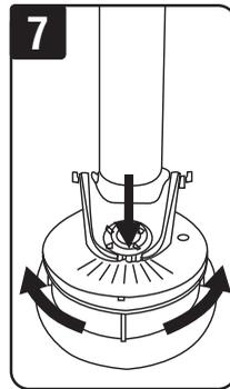
Mientras mayor sea el ajuste, más larga será la descarga. Para ajustar el tapón, gire hacia la izquierda o derecha para obtener la descarga deseada. La configuración de fábrica está al máximo.
