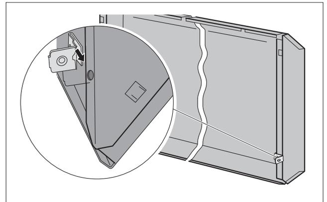
Fig. 38 Positioning snap nut (here: r.h. side panel)
