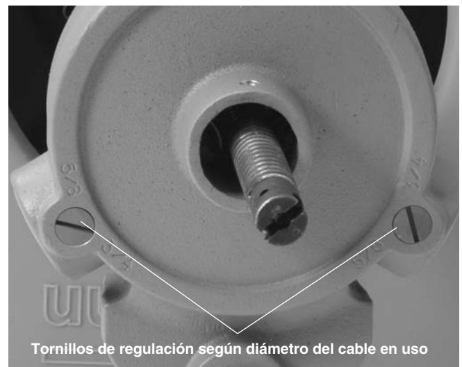
Figura 9 – Tornillos de regulación en la AUTOFEED
