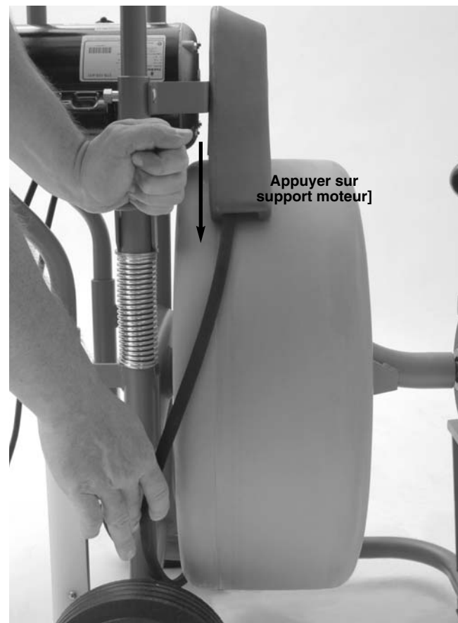
Figure 17 – Pour détendre la courroie
