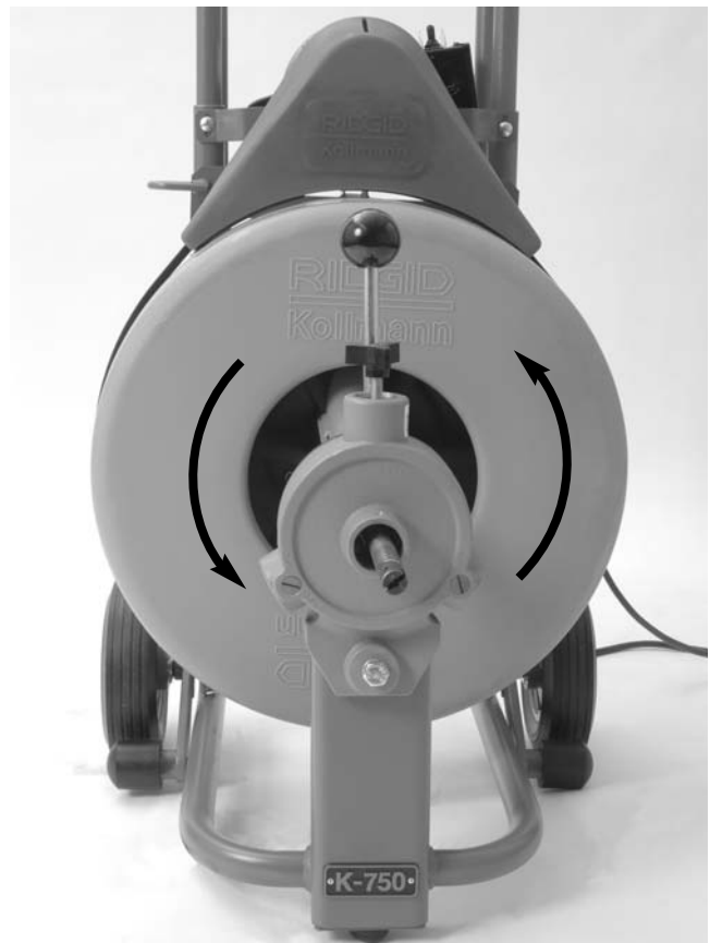
Figura 8 – Con el interruptor en FORWARD (adelante), el tambor debe girar como lo indican las flechas
