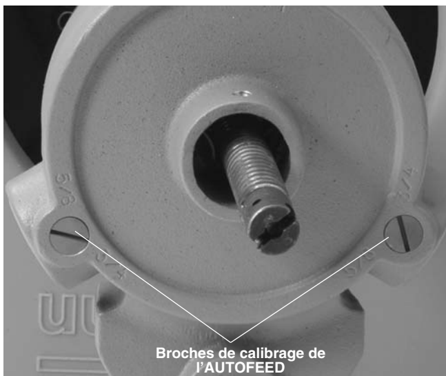
Figure 9 – Broches de calibrage de l'AUTOFEED
