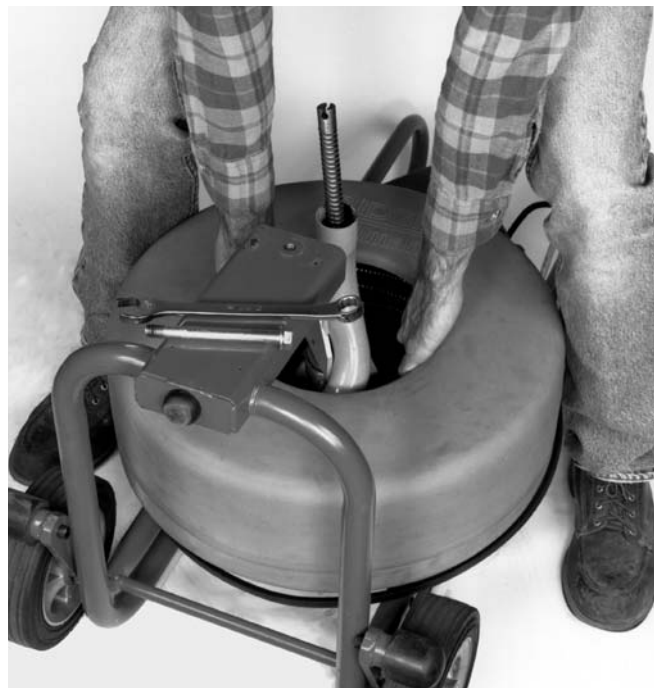
Figura 19 – Extracción del tambor
