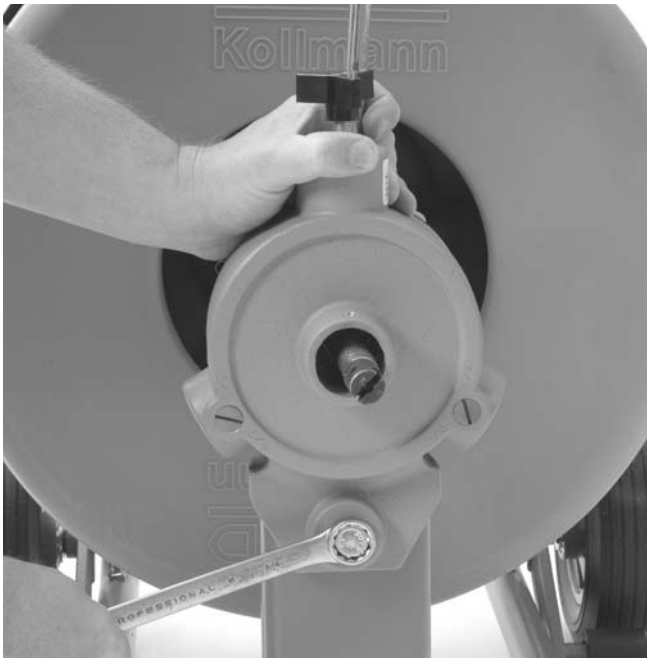
Figura 16 – Extracción del perno de la AUTOFEED
