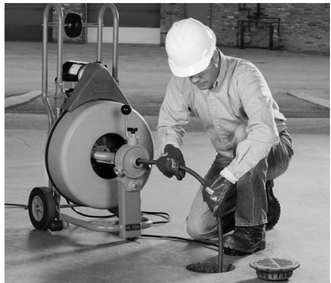
Figure 14 – Utilisation du K-750 avec AUTOFEED
