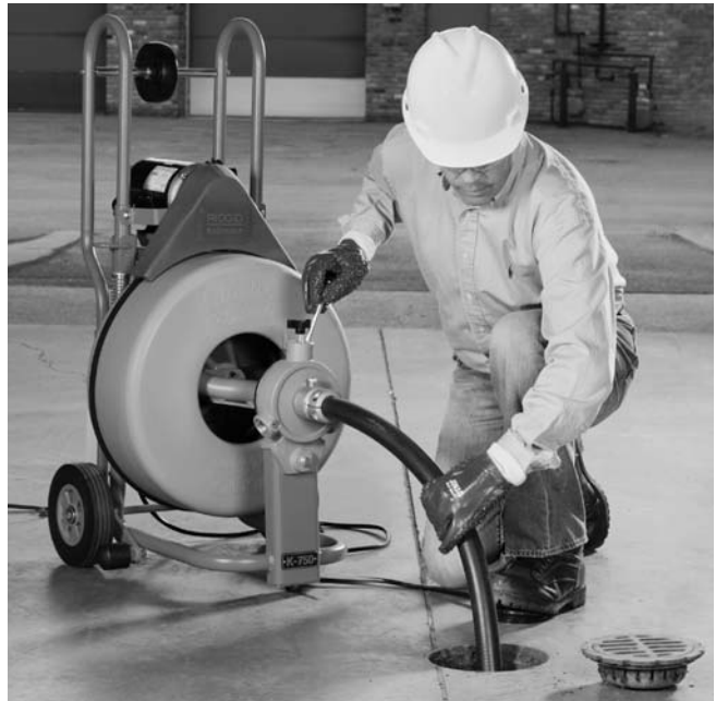
Figure 15 – Utilisation du dégorgeoir avec guide-câble
