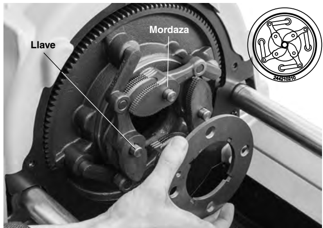
Figura 32 – Cambio de las mordazas en el mandril automático
