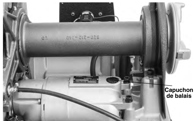
Figure 34 – Retrait du capot et remplacement des balais
