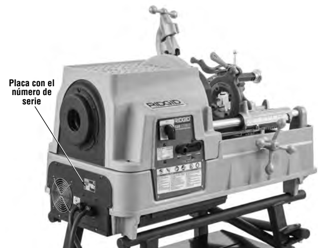
Figura 2B – Roscadora de mandril automático 535
