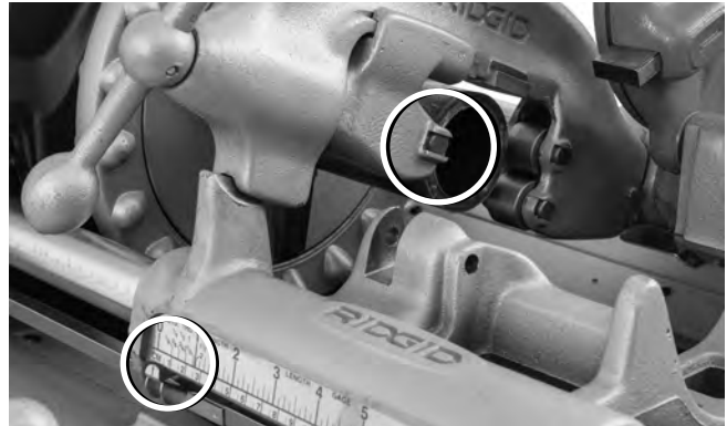
Figura 20 A – Filo de la rueda de corte contra el extremo del tubo. El puntero se coloca en cero (0).
