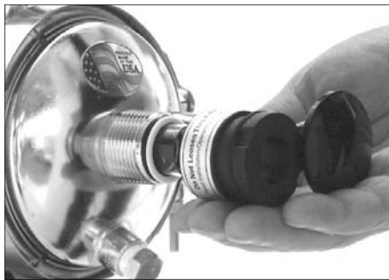
Step 4 - Remove Gland Nuts
