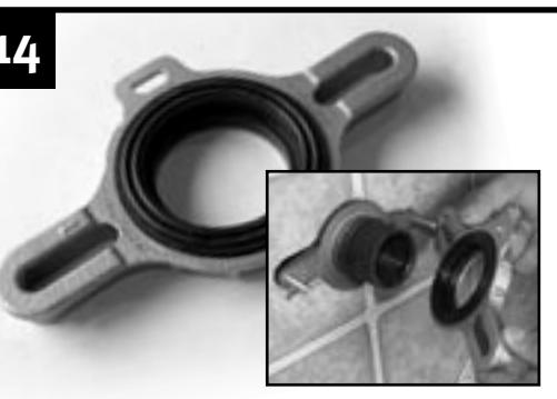
Monter la garniture, nervures vers l'extérieur dans la bride de laiton fournie. Installer la bride avec les noix et rondelles sans la serrer à fond.
