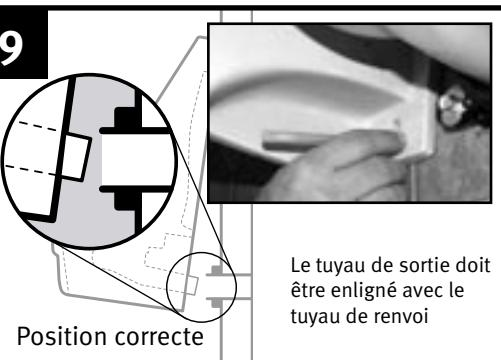
Réaccrocher la cuvette et revérifier encore l'alignement du renvoi. Marquer l'emplacement des ancrages du bas de la cuvette et décrocher la cuvette sans bouger le support.
