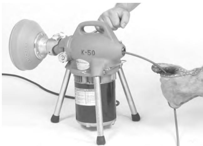
Figura 5 – Acoplamiento del adaptador para el cable
