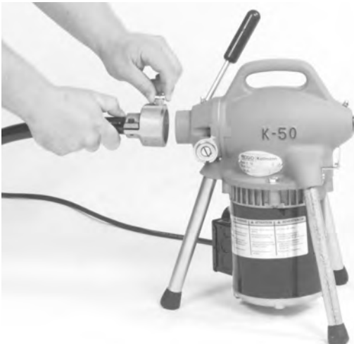
Figure 2 – Montage du guide-câble arrière
