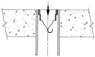
PART NO. TG22IP 2" INSERT FITS INSIDE 2" CAST IRON PIPE
