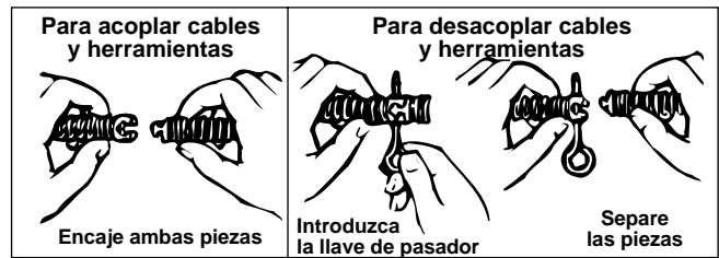
Figura 5 – Modo de acoplar y desacoplar cables y herramientas
