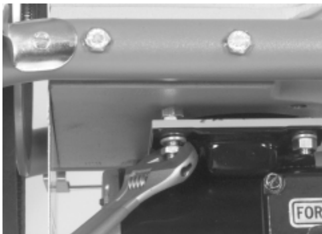
Figure 14 – Élimination du jeu de l'embrayage
