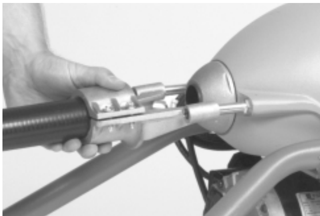
Figure 3 – Montage du guide-câble arrière
