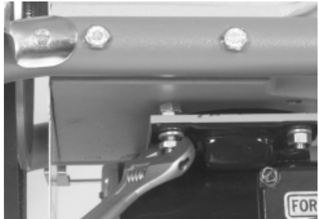
Figura 14 – Eliminación del juego (holgura) del embrague
