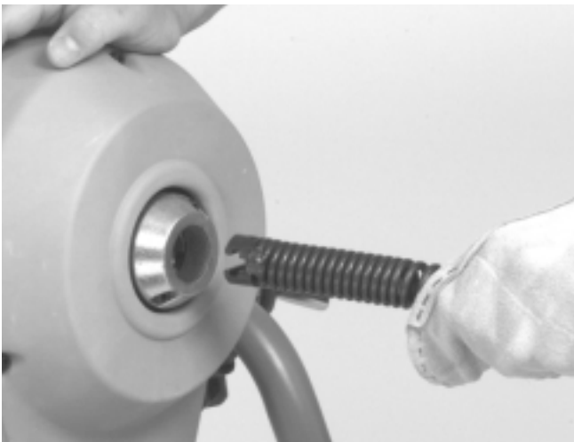
Figura 4 – Introducción del cable por la parte delantera de la máquina
