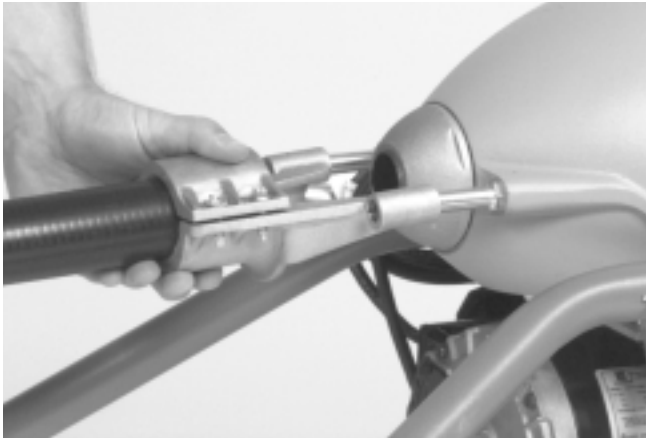
Figura 3 – Acoplamiento de la manguera guía trasera
