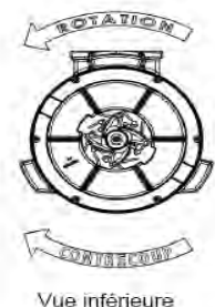
Fig. A – Bonne rotation du rotor, modèles triphasés
