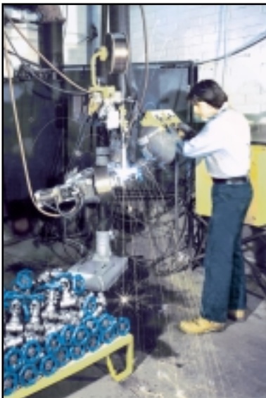
Automatic MIG welder.
