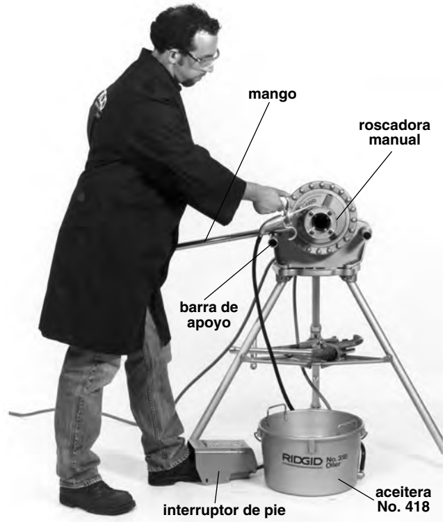
Figura 8 – Roscado con una roscadora manual
