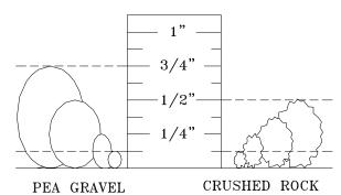
BACKFILL MATERIAL REQUIREMENTS
