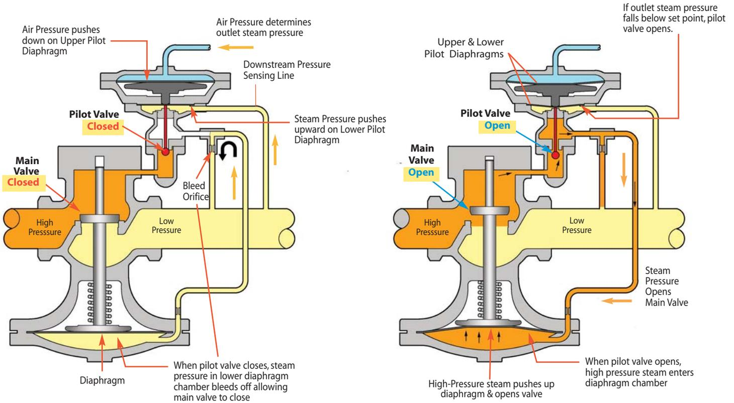
MAXIMUM CONTROL AIR PRESSURE ON AIR PILOT IS 125 PSIG
