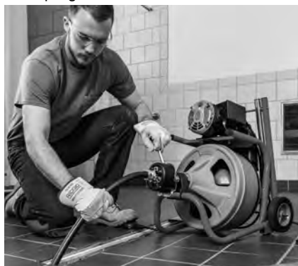
Figura 16 – Uso de la máquina con manguera-guía
