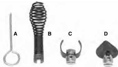
Figure 11 – Outils de curage fournis avec le K-400
