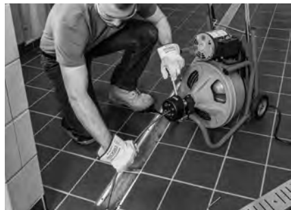
Figure 15 – Utilisation du K-400 avec AUTOFEED
