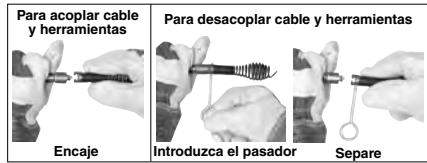
Figura 12 – Acoplamiento y desacoplamiento de herramientas al cable
