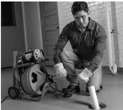
Figure 10 – Exemple d'un fourreau amenant le câble exposé à moins de 2' (60 cm) du dégorgeoir
