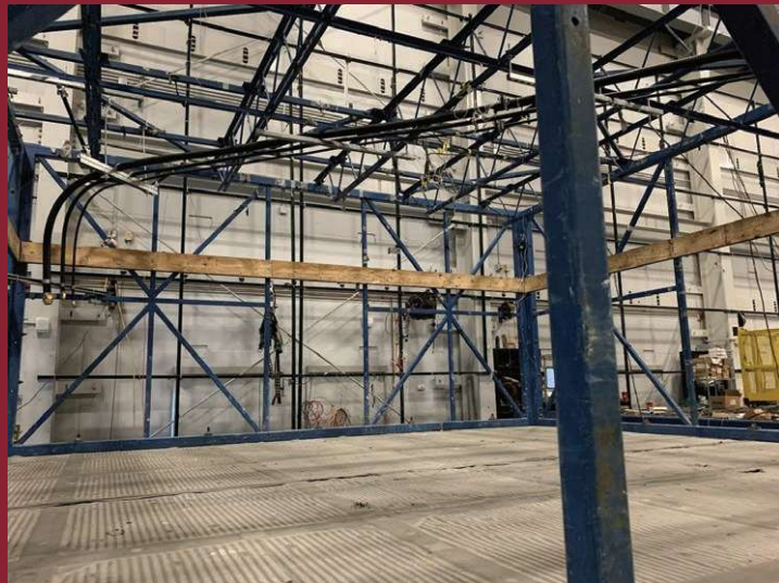
CounterStrike® CSST in seismic test rig.
