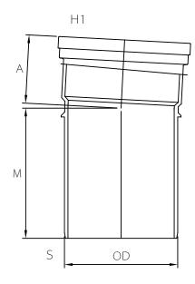
INJECTION MOLDED FITTING (M)
