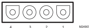
Fig. 3. Configuration de la fiche du faisceau de l'allumeur/de la roue de tirage du S9200U1000.
