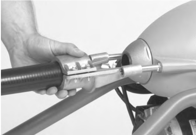
Figure 3 – Montage du guide-câble arrière
