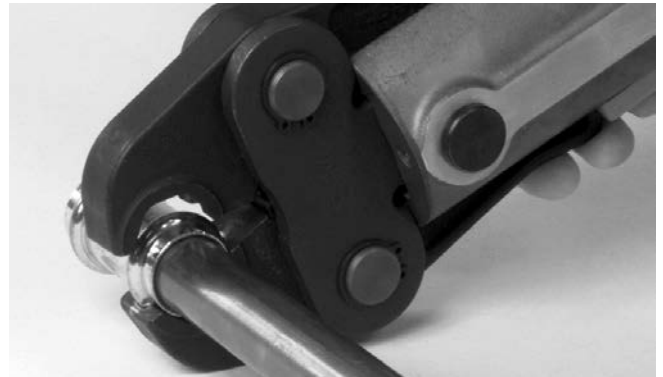
Figure 11 – Ouverture et positionnement des mâchoires autour d'un raccord
