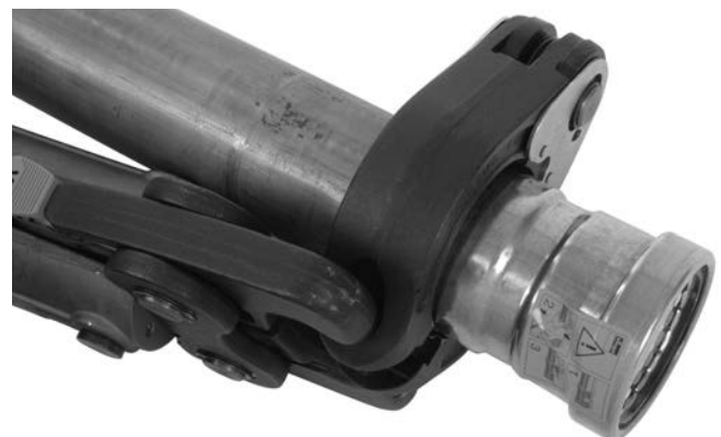
Figure 14C – Déviation de l'actionneur V2 dans les logements de bague XL-C pour faciliter l'accès
