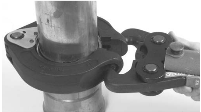
Figura 14A – Las puntas del accionador V2 asentadas en las cavidades del aro XL-C
