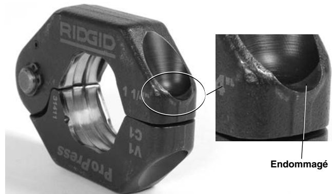
Figure 13 – Logement de bague endommagé
