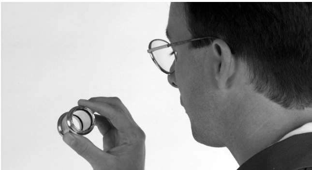
Figura 6A – Inspección del acoplamiento ProPress de acuerdo a las instrucciones de su fabricante
