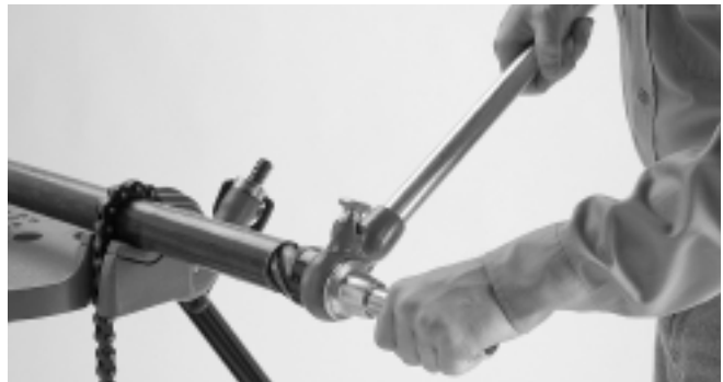
Figure 2 – Alésage de l'extrémité du tuyau
