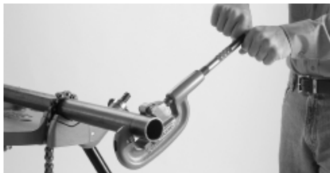
Figure 1 – Coupe de l'extrémité du tuyau
