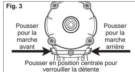
Pour une rotation **en marche avant** (dans le sens horaire), pousser le commutateur sur le côté droit de l'outil. **Vérifier la direction de rotation avant utilisation.**
