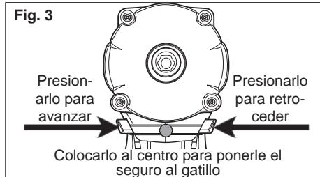
Para **avanzar** (el giro es en el sentido de las manecillas del reloj), se presiona el interruptor de control colocado al lado derecho del taladro. **Verificar la dirección del giro antes de usarlo.**
