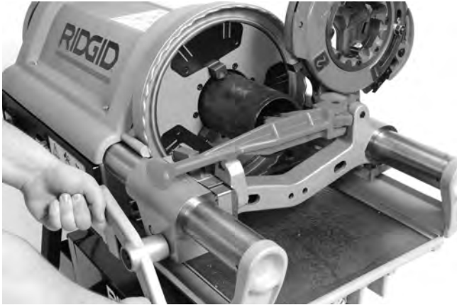
Figura 22 – Escariado de un tubo con el escariador
