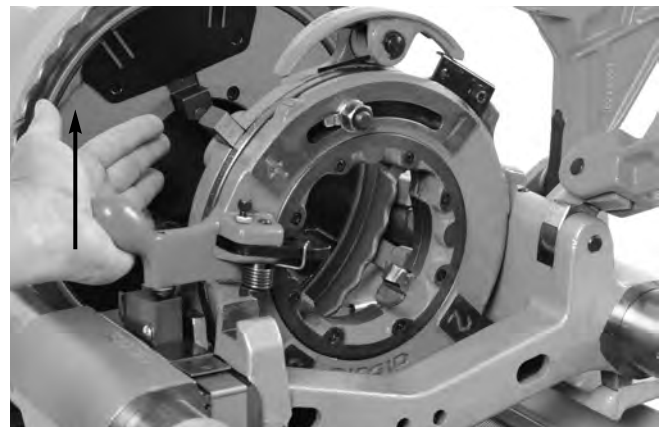
Figure 16 – Fermeture de la tête de filière rétractable
