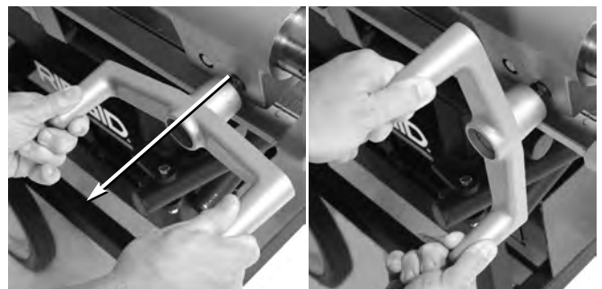
Figure 20 – Réglage du volant du chariot
