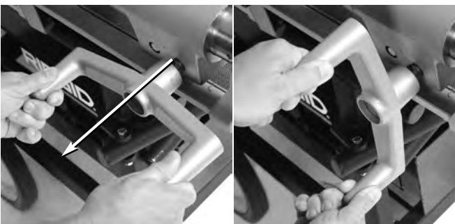
Figura 20 – Ajuste del volante del carro
