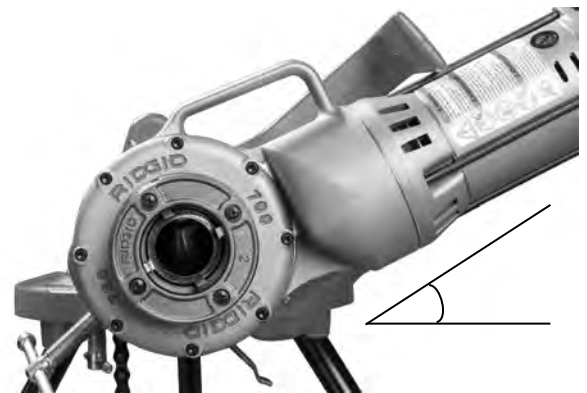
Figura 6 – Brazo de soporte con el accionamiento motorizado 700 colocado ligeramente encima de la línea horizontal
