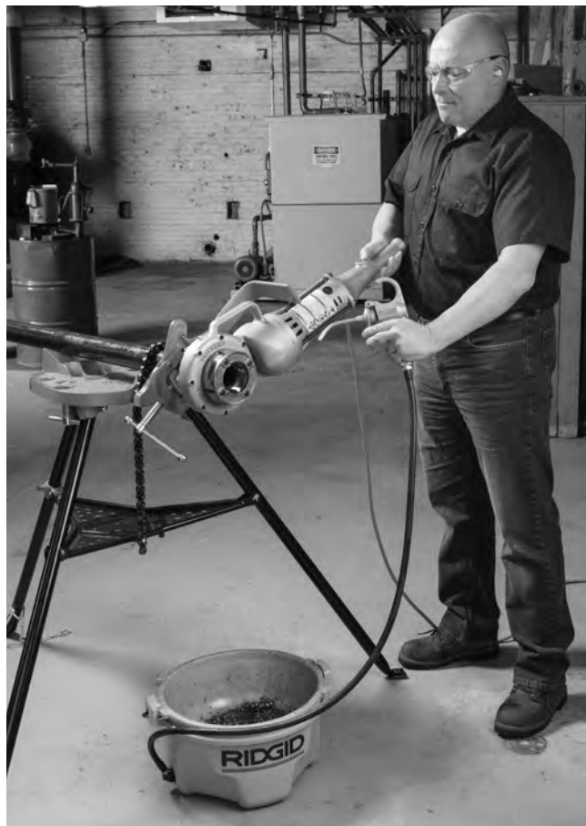
Figure 9 – Filetage des tuyaux
