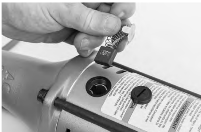
Figura 13 – Colocación de la escobilla
