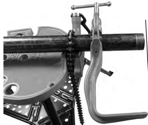
Figura 5 – Brazo de soporte alineado con el extremo del tubo
