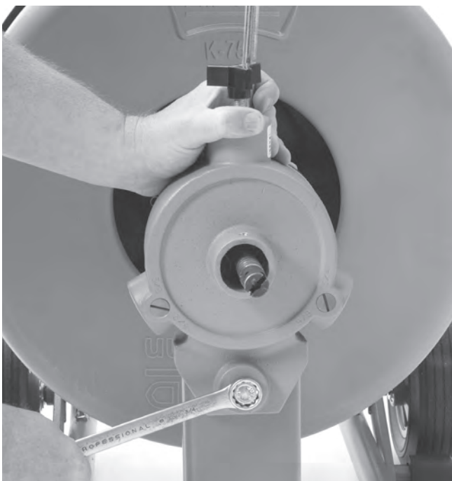
Figure 17 – Retrait de l'AUTOFEED
