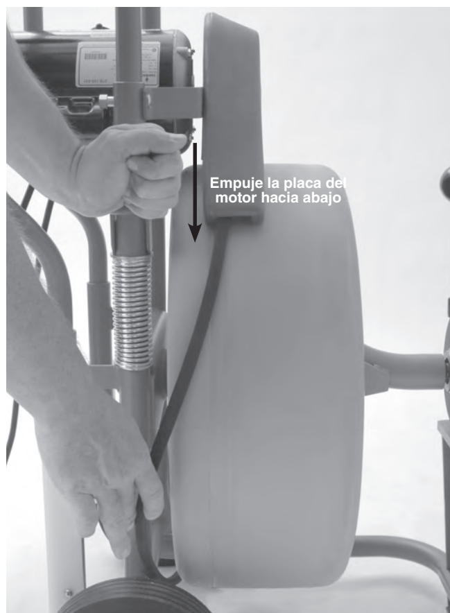
Figura 18 – Cómo aflojar la tensión de la correa
