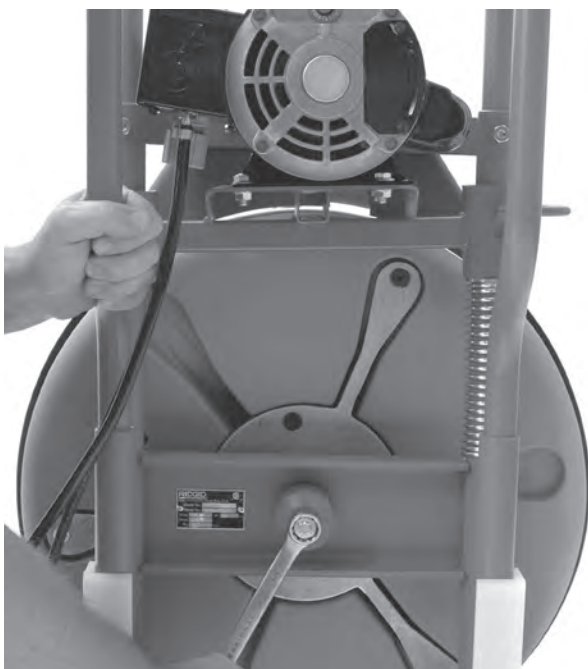
Figura 19 – Extracción del pasador del tambor
