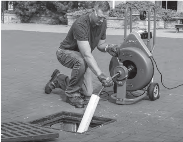
Figura 10 – Ejemplo de cómo extender el desagüe para que el acceso quede a menos de 3 pies de la salida del cable
