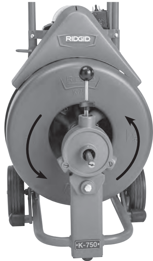
Figure 8 – Sens de rotation approprié du tambour (commutateur en position FOR)
