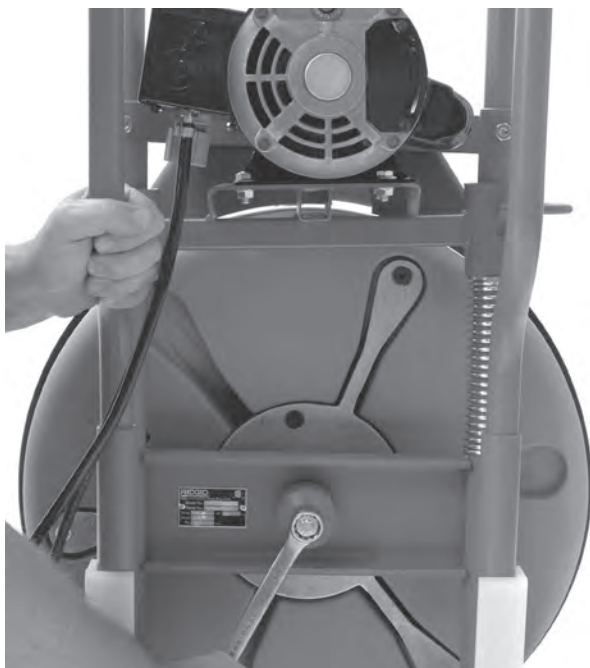
Figure 19 – Retrait du boulon du tambour
