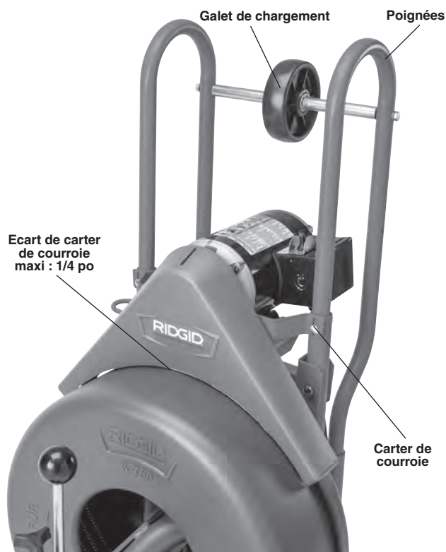
Figure 3 – Montage des poignées et réglage du carter de courroie
