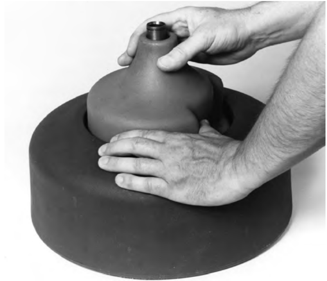
Figure 15 – Dépose du tambour interne
