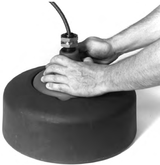
Figure 13 – Retrait de l'embout du câble
