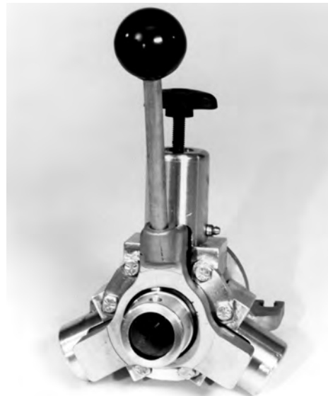
Figure 8 – Système d'avance automatique
