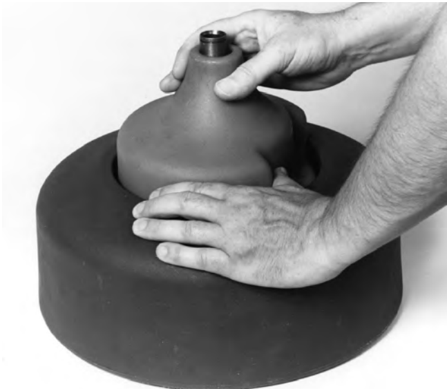
Figura 15 – Extracción del tambor interior
