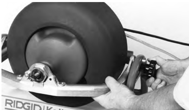
Figura 1 – Conjunto de horquilla pivotante
