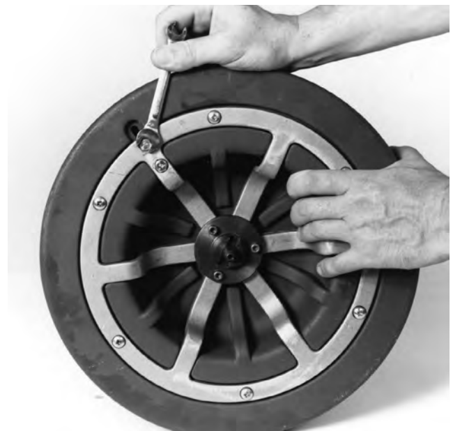
Figure 12 – Desserrage de l'étrier de câble
