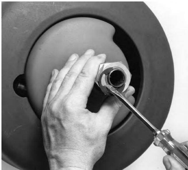
Figure 14 – Enlèvement des cerclips
