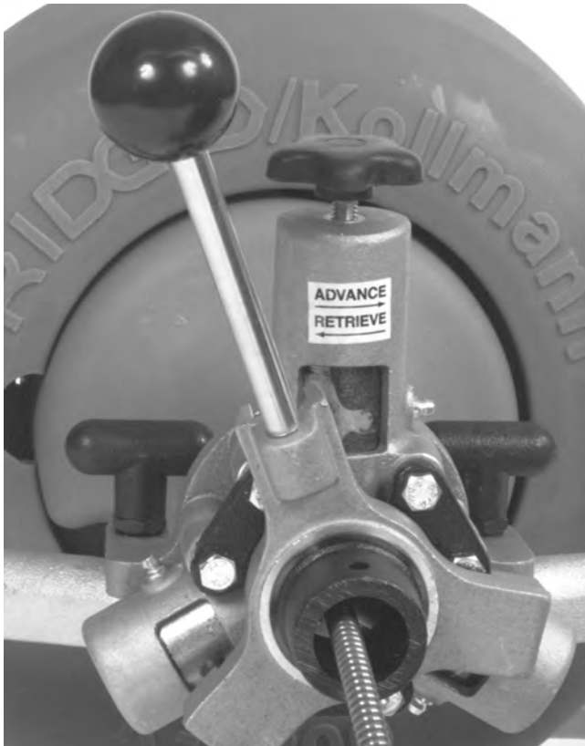
Figura 9 – Alimentador AUTOFEED en posición de reversa
