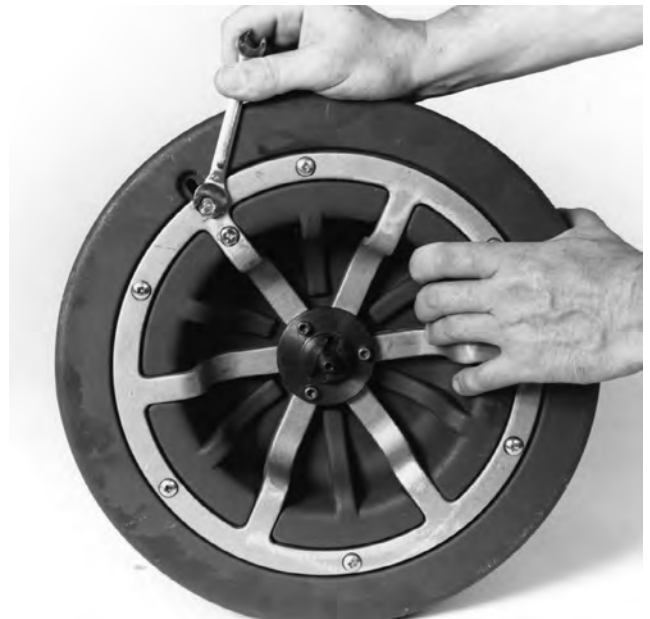
Figura 12 – Cómo aflojar la pieza de sujeción del cable
