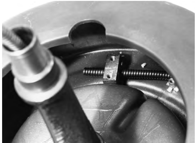
Figura 16 – Colocación del nuevo cable debajo del soporte de sujeción
