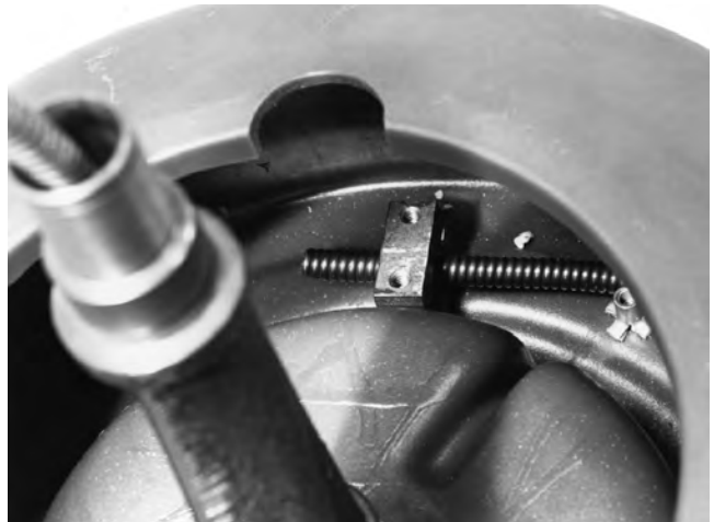
Figure 16 – Position du nouveau câble dans le collier
