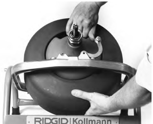
Figure 2 – Alignement du tambour sur la boîte de vitesses
