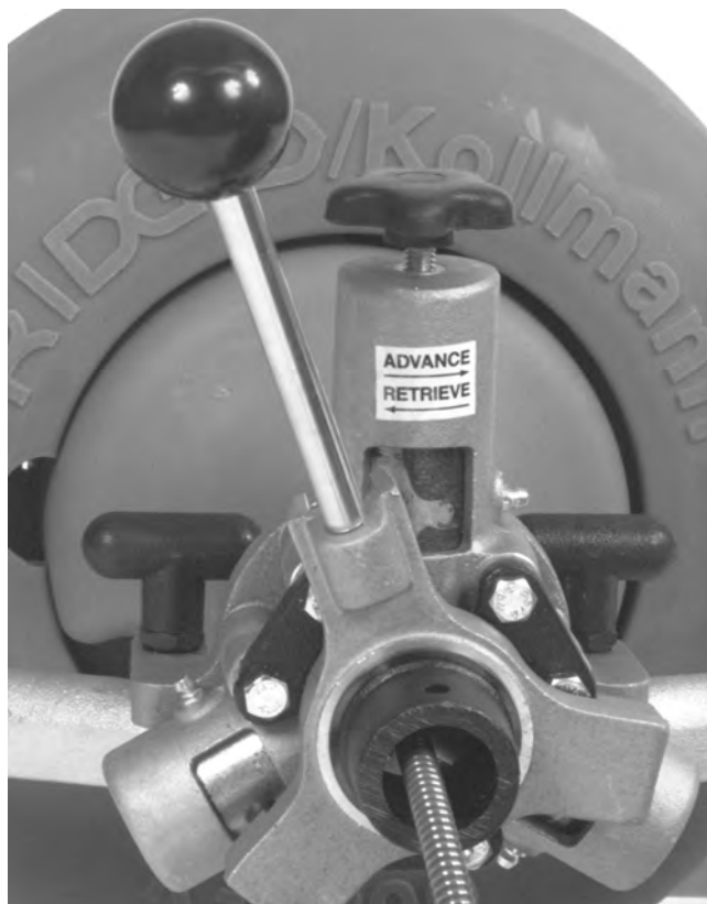
Figure 9 – Système d'avance automatique en marche arrière
