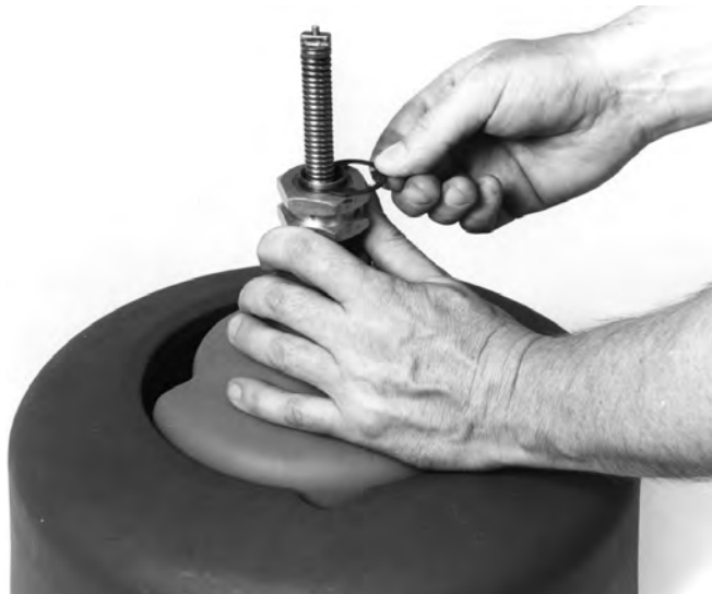
Figura 17 – Instalación del tambor interior, soporte delantero y clips de tipo E
