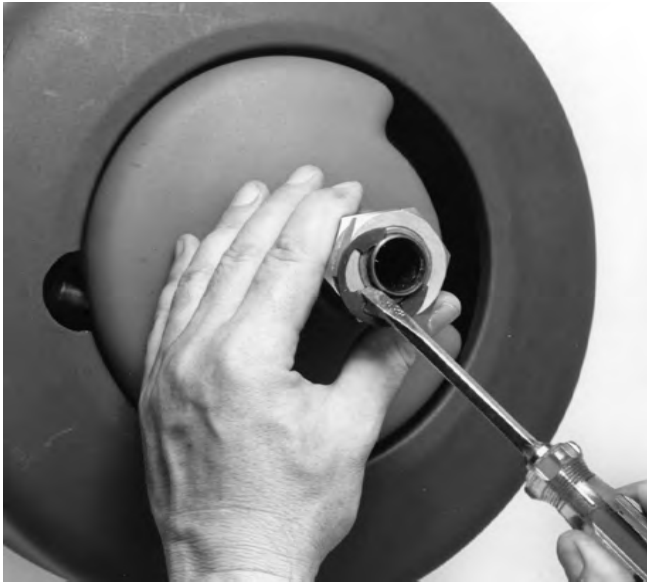
Figura 14 – Extracción de los clips tipo E
