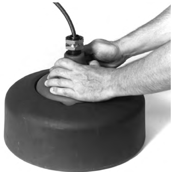
Figura 13 – Extracción del extremo del cable
