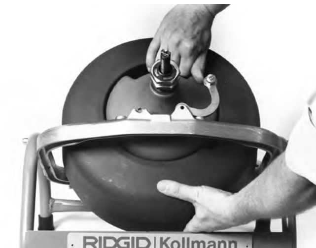
Figura 2 – Alineamiento del tambor con el agujero de la caja de cambios
