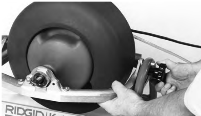
Figure 1 – Basculement du berceau du tambour
