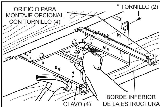
Abra las BARRAS DE SUSPENSIÓN hasta el ancho de la estructura.
