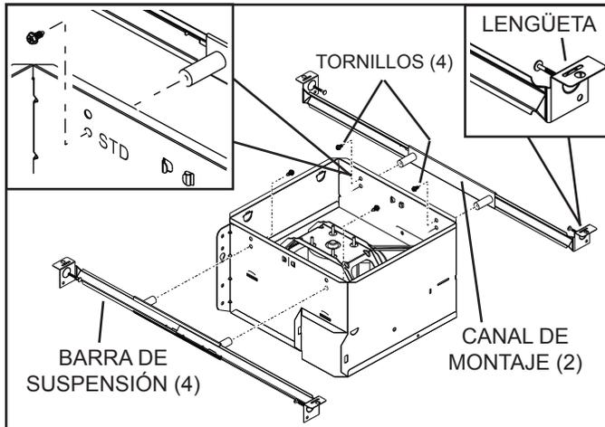
Fije los CANALES DE MONTAJE a la cubierta con los TORNILLOS incluidos. Asegúrese de que las LENGÜETAS estén de cara hacia arriba, tal como se muestra. Utilice el conjunto de orificios de montaje (marcados como "STD") para montar la cubierta al ras con la parte inferior de la tablaroca. Utilice el otro conjunto de orificios (sin marca) para montar la cubierta al ras con la parte superior de la tablaroca.
