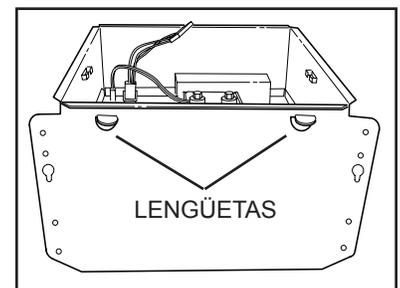
Con alicates, doble las LENGÜETAS de la cubierta a un ángulo de 90°. Sos- tenga la cubierta en su lugar de manera que las lengüetas de la cubierta hagan contacto con la parte inferior de la vigueta. Para el montaje de la cubierta se utilizan cuatro (4) tornillos o clavos. Atornille o clave la cubierta a la vigueta a través de los orificios más bajos de cada brida de montaje, y seguidamente a través de los más altos.
