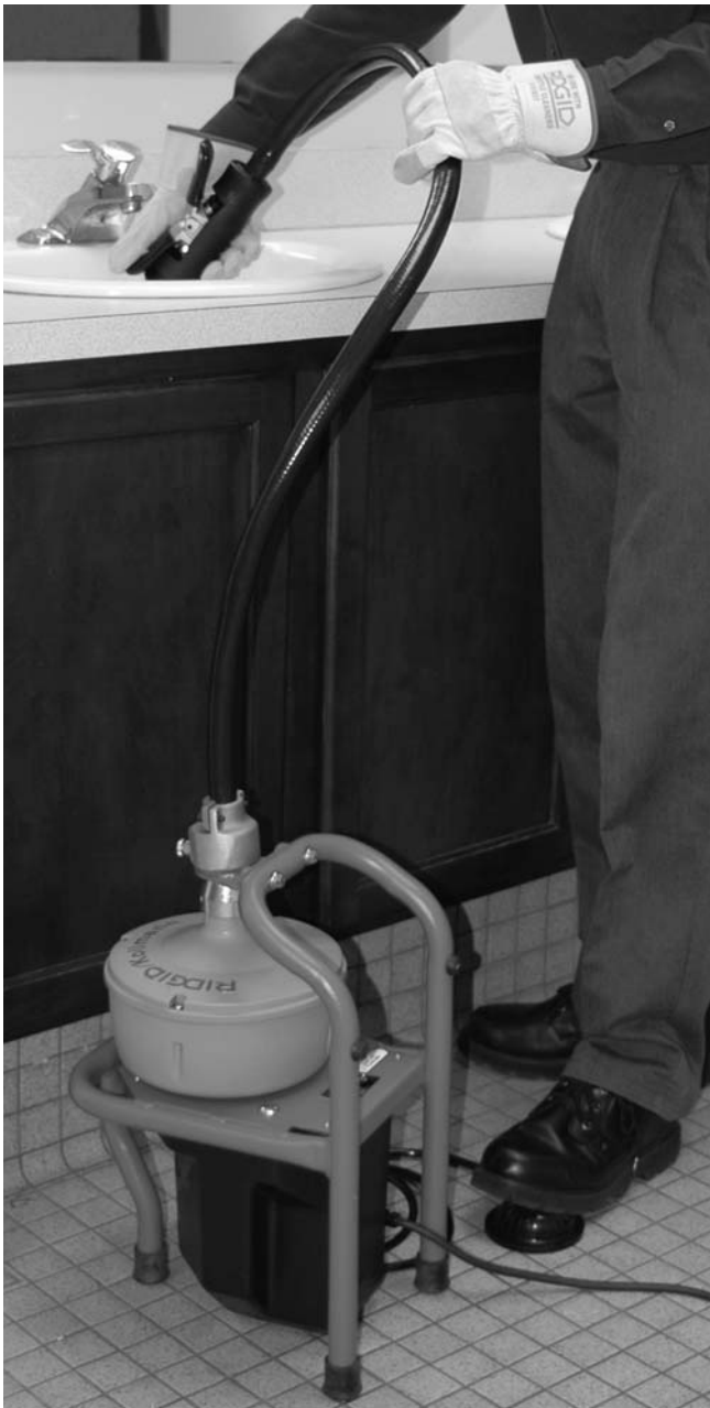
Figura 13 – Empleo de la K-40 con AUTOFEED
