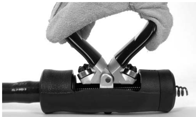
Figura 5 – Introducción del cable por el AUTOFEED
