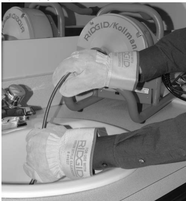
Figure 11 – Avancement manuel du câble
