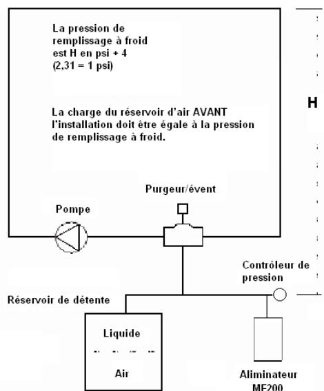
Par exemple, la pression de remplissage statique à froid pour un système ayant une hauteur statique au-dessus du point de remplissage de 40 pieds sera :  $(40/2,31) + 4 = 21,3 \text{ psi}$
