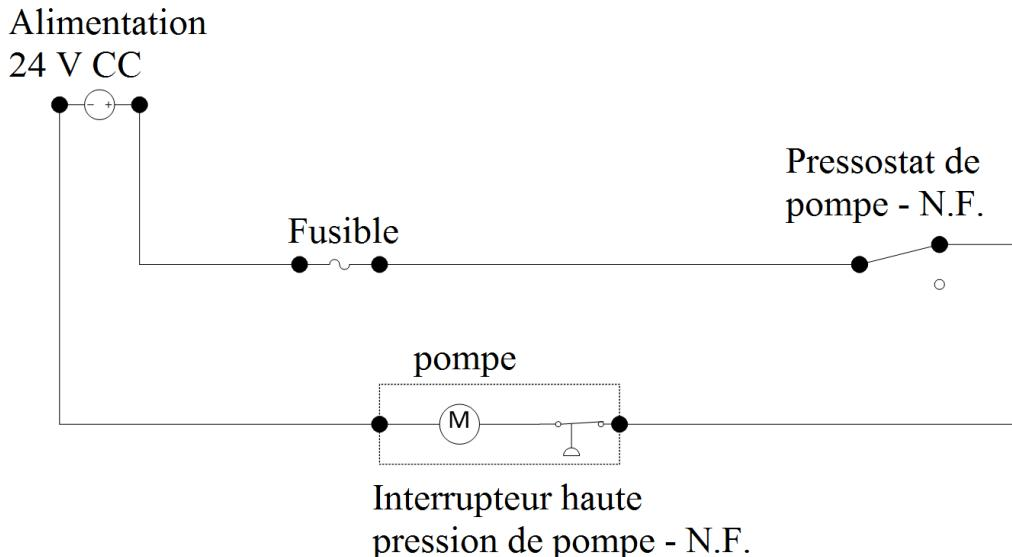
*Remarque - l'état des interrupteurs illustrés dans ce feuillet vaut pour un appareil tel qu'il sort de son emballage, sans fluide dans le réservoir et sans pression dans le système.*
