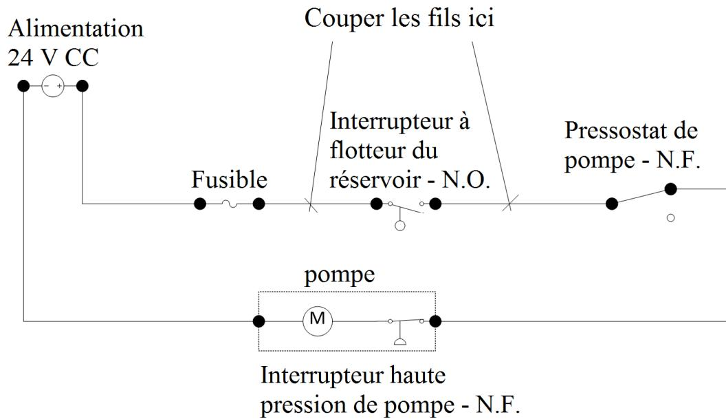
2. Branchez les fils pour réaliser un circuit sans l'interrupteur à flotteur.
