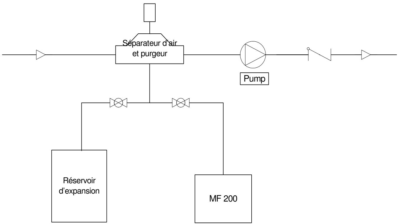
Schéma de raccordement – Ensemble d'alimentation MF
