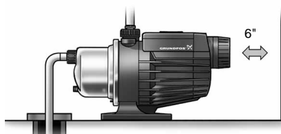
Fig. 5 Dégagement minimal derrière la pompe
