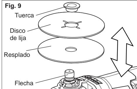
4. Coloque el disco abrasivo en el respaldo asegúrelo a la flecha con la tuerca.
