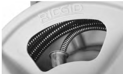
Figure 18 – Enrouler le câble dans le tambour comme indiqué
