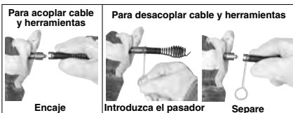
Figura 12 – Acoplamiento y desacoplamiento de herramientas al cable
