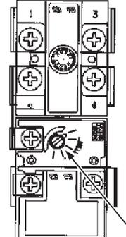
ADJUSTABLE UPPER THERMOSTAT BEHIND UPPER ACCESS PANEL (DUAL ELEMENT MODELS ONLY)
